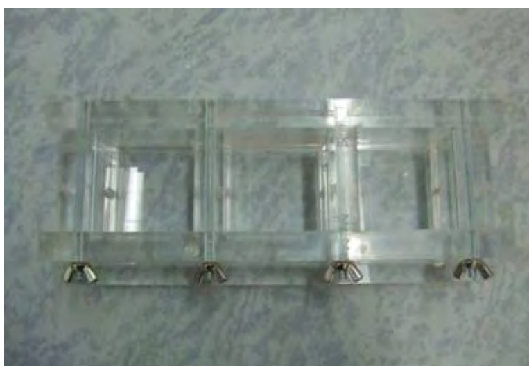
รูปที่ 3.2 แบบหล่อมอร์ตาร์พลาสติกขนาด 5×5×5 ซม.
