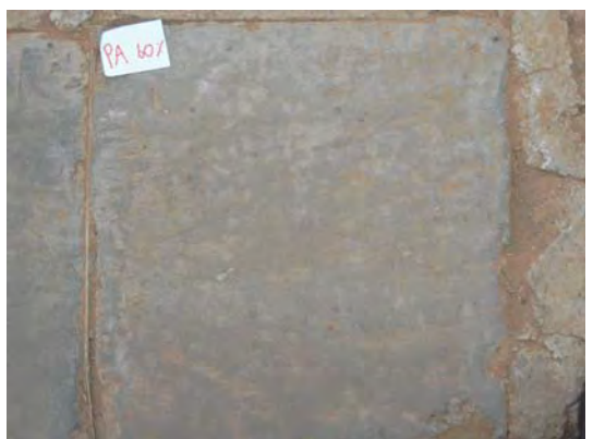
รูปที่ 30 สภาพพื้นคอนกรีต PA60 ในการทดสอบการใช้งานจริง ที่ระยะเวลา 1 และ 6 เดือน
