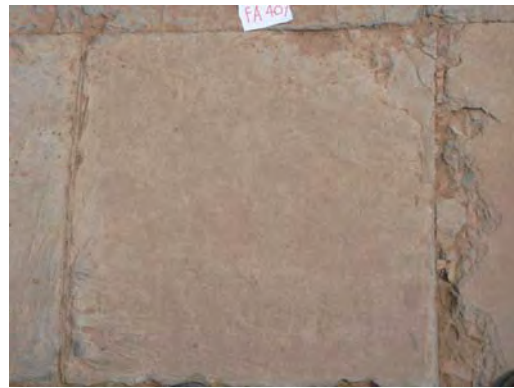
รูปที่ 26 สภาพพื้นคอนกรีต FA40 ในการทดสอบการใช้งานจริง ที่ระยะเวลา 1 และ 6 เดือน
