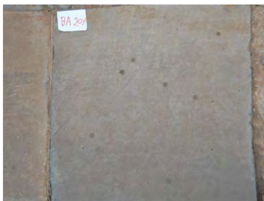
รูปที่ 31 สภาพพื้นคอนกรีต BA20 ในการทดสอบการใช้งานจริง ที่ระยะเวลา 1 และ 6 เดือน
