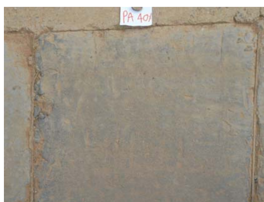
รูปที่ 29 สภาพพื้นคอนกรีต PA40 ในการทดสอบการใช้งานจริง ที่ระยะเวลา 1 และ 6 เดือน
