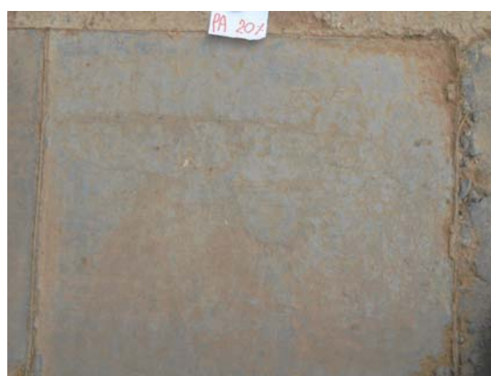
รูปที่ 28 สภาพพื้นคอนกรีต PA20 ในการทดสอบการใช้งานจริง ที่ระยะเวลา 1 และ 6 เดือน
