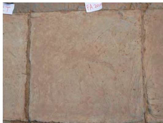
รูปที่ 25 สภาพพื้นคอนกรีต FA20 ในการทดสอบการใช้งานจริง ที่ระยะเวลา 1 และ 6 เดือน
