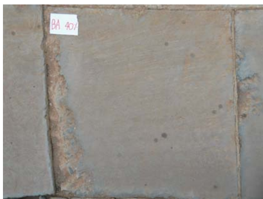
รูปที่ 32 สภาพพื้นคอนกรีต BA40 ในการทดสอบการใช้งานจริง ที่ระยะเวลา 1 และ 6 เดือน
