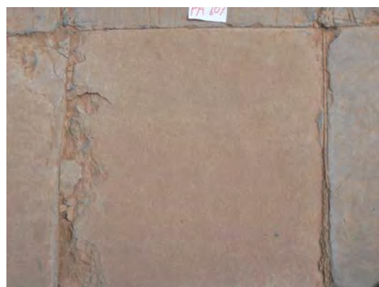
รูปที่ 27 สภาพพื้นคอนกรีต FA60 ในการทดสอบการใช้งานจริง ที่ระยะเวลา 1 และ 6 เดือน
