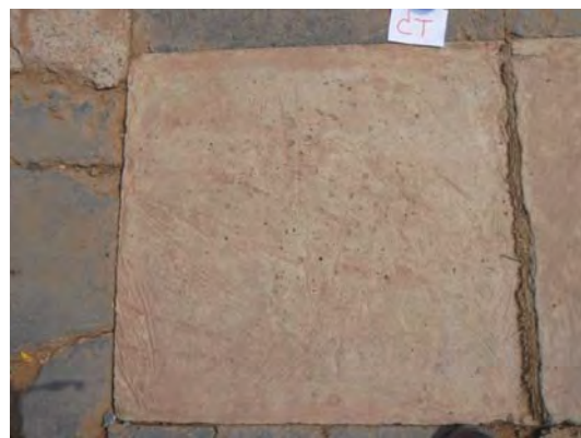
รูปที่ 24 สภาพพื้นคอนกรีตควบคุม (CON) ในการทดสอบการใช้งานจริง ที่ระยะเวลา 1 และ 6 เดือน
