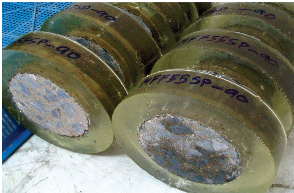
รูปที่ 7 ตัวอย่างคอนกรีตที่ทำการหล่ออีพอกซีเรียบร้อยแล้วพร้อมทำการทดสอบ
