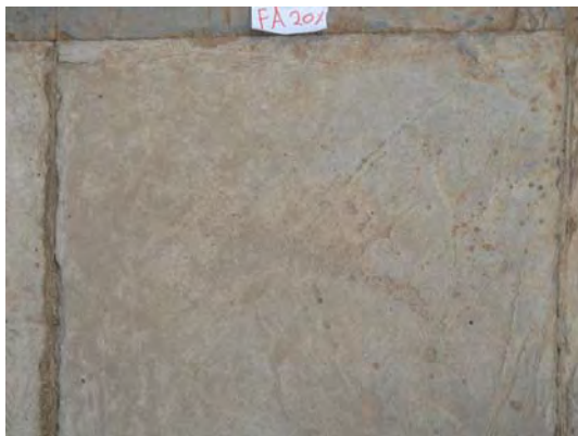
รูปที่ 25 สภาพพื้นคอนกรีต FA20 ในการทดสอบการใช้งานจริง ที่ระยะเวลา 1 และ 6 เดือน
