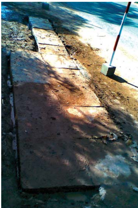
รูปที่ 4 การทดสอบการสึกกร่อนในสภาพการใช้งานจริง โดยทำบนถนนที่มีการใช้งานสัณฐานภายในมหาวิทยาลัย
