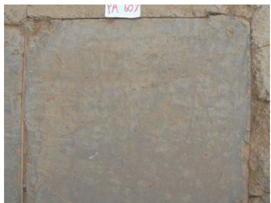
รูปที่ 30 สภาพพื้นคอนกรีต PA60 ในการทดสอบการใช้งานจริง ที่ระยะเวลา 1 และ 6 เดือน
