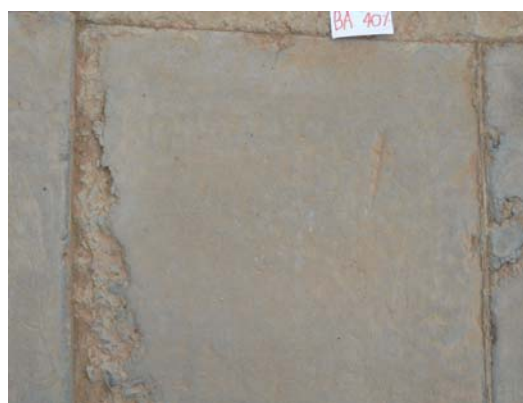
รูปที่ 32 สภาพพื้นคอนกรีต BA40 ในการทดสอบการใช้งานจริง ที่ระยะเวลา 1 และ 6 เดือน
