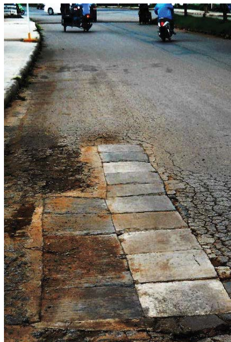
รูปที่ 4 การทดสอบการสึกกร่อนในสภาพการใช้งานจริง โดยทำบนถนนที่มีการใช้งานสัณฐานภายในมหาวิทยาลัย
