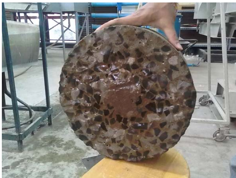
รูปที่ 3 ตัวอย่างคอนกรีตที่ผ่านการทดสอบการต้านทานการสึกกร่อน (Abrasion resistance, ASTM C1138)
