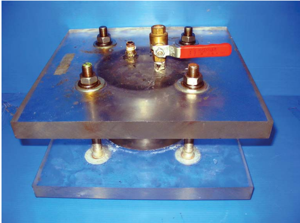
รูปที่ 8 อุปกรณ์ที่ทำการติดตั้งตัวอย่างคอนกรีตแล้ว
