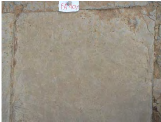
รูปที่ 26 สภาพพื้นคอนกรีต FA40 ในการทดสอบการใช้งานจริง ที่ระยะเวลา 1 และ 6 เดือน
