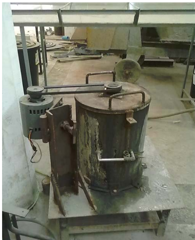
รูปที่ 2 เครื่องทดสอบการต้านทานการสึกกร่อน (Abrasion resistance, ASTM C1138)
