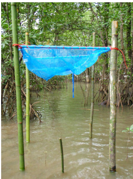
ภาพที่ 4 กระบะขนาด 1x1 ตารางเมตร เพื่อรองรับการร่วงหล่นซากพืช (Litter trap)
