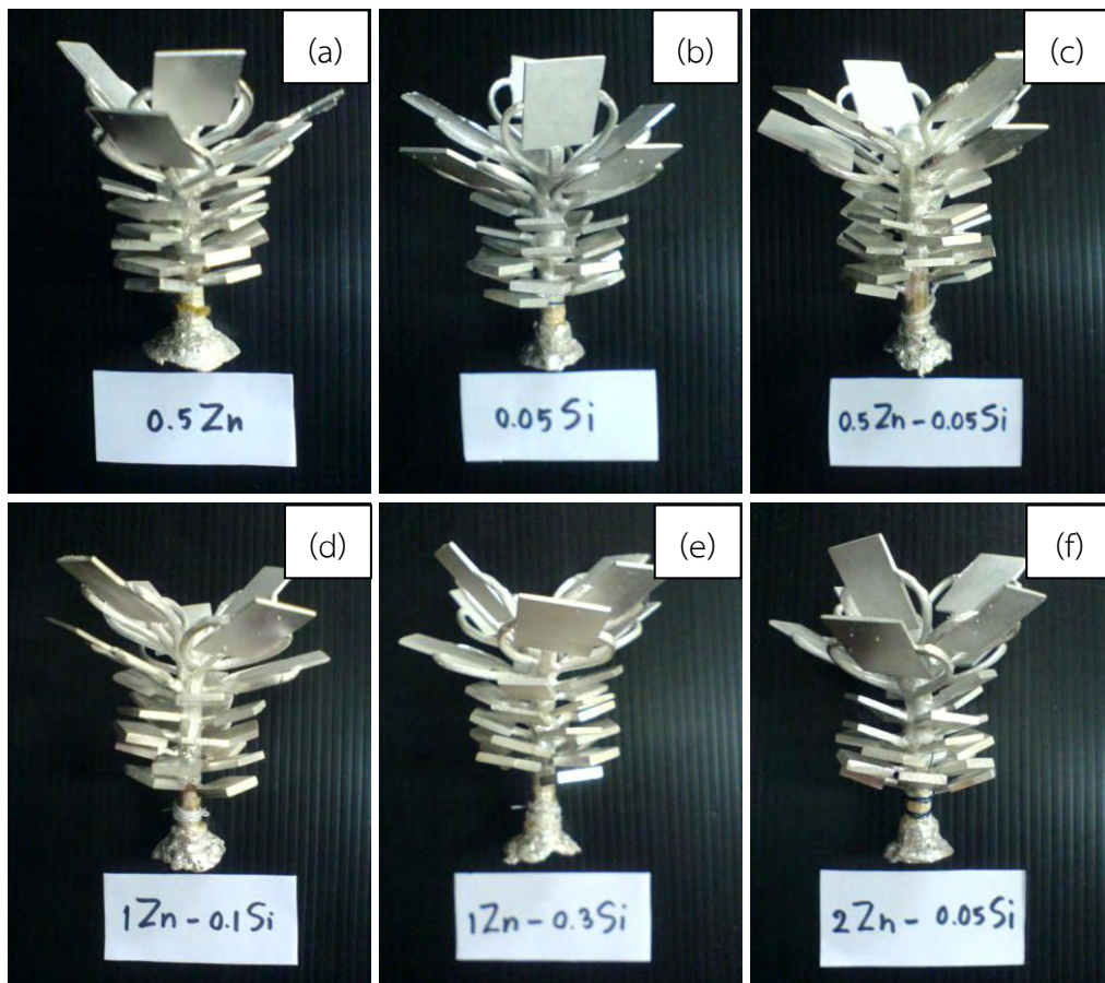
รูปที่ 3.5 ต้นเงินขึ้นทดสอบ 935Ag ระบบ Ag-Cu-Zn-Si (a) 0.5Zn (b) 0.05Si (c) 0.5Zn-0.05Si (d) 1.0Zn-0.1Si (e) 1.0Zn-0.3Si และ (f) 2.0Zn-0.05Si
