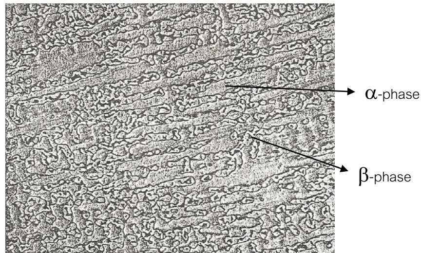
รูปที่ 2.9 โครงสร้างจุลภาคแบบเดนไดรต์ของเงินสเตอร์ลิง (Reti, 1997)
