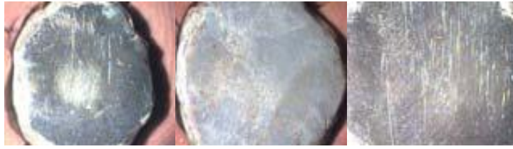
รูปที่ 2.10 ลักษณะผิวโลหะผสมเงินที่ผ่านการทดสอบการหมองภายใต้สภาวะของสารละลายโซเดียมซัลไฟด์ ( \text{Na}_2\text{S} ) 30 50 และ 70% (สมนึก วัฒนศรีกุล และคณะ, 2544)
