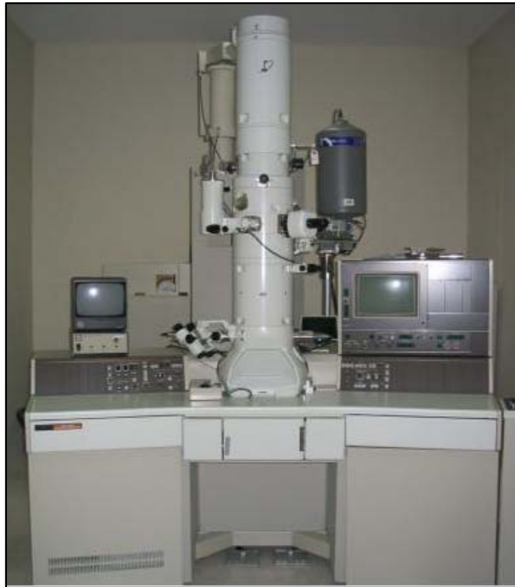
รูปที่ 3.14 กล้องจุลทรรศน์อิเล็กตรอนแบบส่องผ่าน JEOL รุ่น JEM-2010
