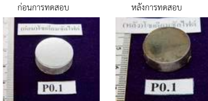
รูปที่ 2.11 ชิ้นงาน Ag-Cu-Zn-In ก่อนและหลังทดสอบกันหมองด้วย \text{Na}_2\text{S} (สมนึก วัฒนศรีกุล และคณะ, 2544)
