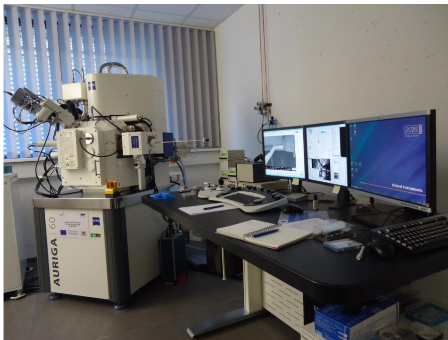
รูปที่ 3.12 Focused Ion Beam (FIB) Zeiss รุ่น AURIGA 60
