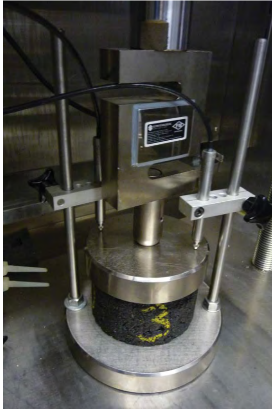
รูปที่ 3.9 การติดตั้งก่อนตัวอย่างในการทำ Dynamic Creep Test
