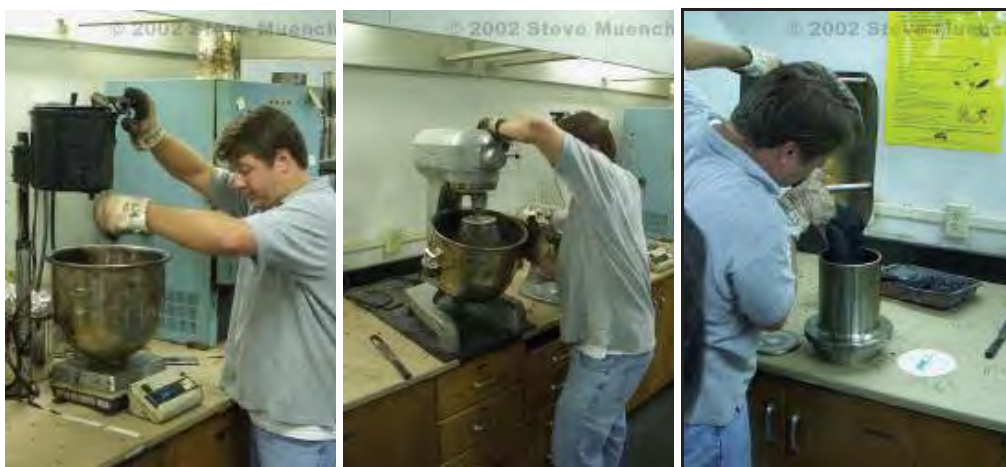
รูปที่ 2.5 รูปแสดงการ ผสมและทำตัวอย่างแอสฟัลต์สำหรับการออกแบบส่วนผสมแอสฟัลต์ (WAPA pavement guide,2007)
