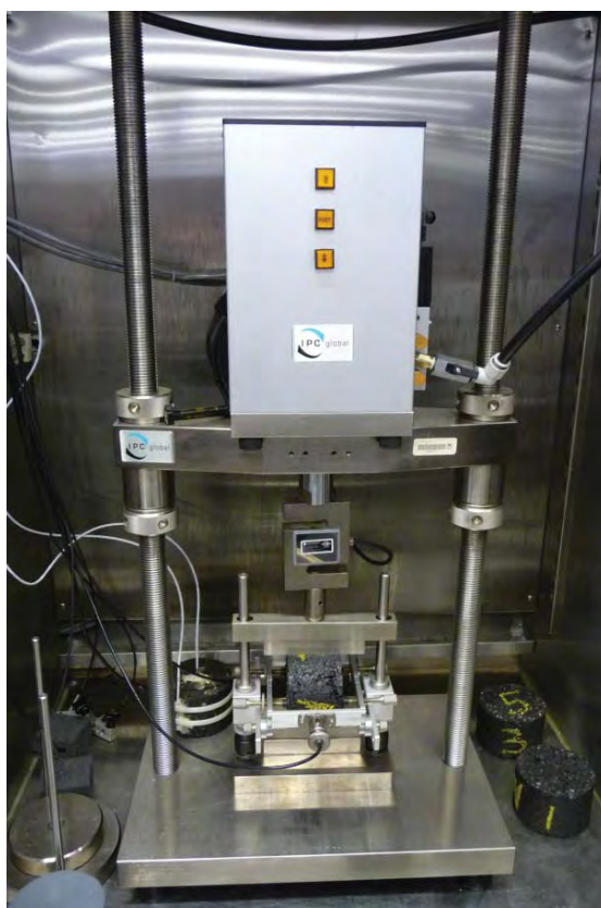
รูปที่ 3.6 การติดตั้งก่อนตัวอย่างในการทำ Indirect Resilient Modulus Test
