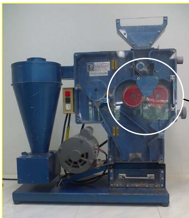
ภาพประกอบ 12 แสดงการกำหนดระยะห่างระหว่างลูกยางกะเทาะข้าวเปลือกของ เครื่องกะเทาะข้าวเปลือก
