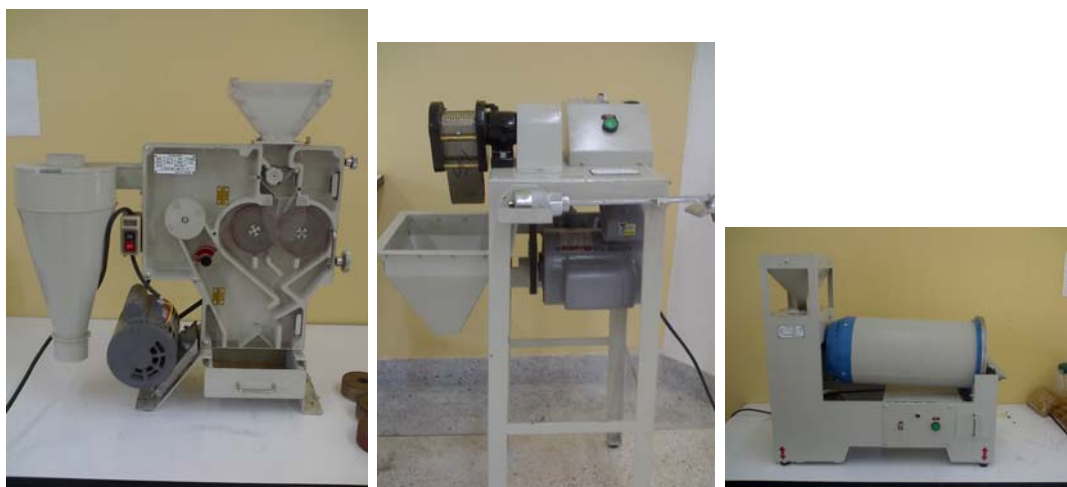
ภาพประกอบ 2 เครื่องกะเทาะข้าวเปลือกแบบลูกยางคู่และขัดขาวข้าวกล้อง และเครื่องคัดขนาดข้าวสาร ที่ผลิตในประเทศ ชุดที่ 1 (Ngek Seng Huat LTD.,Part.)
