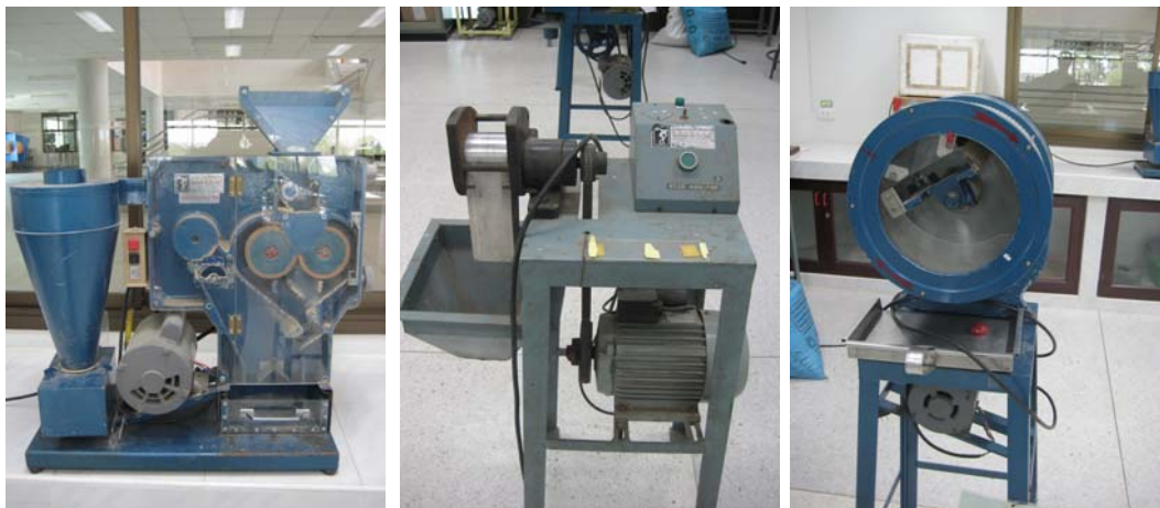
ภาพประกอบ 2 เครื่องกะเทาะข้าวเปลือกแบบลูกยางคู่และขัดขาวข้าวกล้อง และเครื่องคัดขนาดข้าวสาร ที่ผลิตในประเทศ ชุดที่ 1 (Ngek Seng Huat LTD.,Part.)
