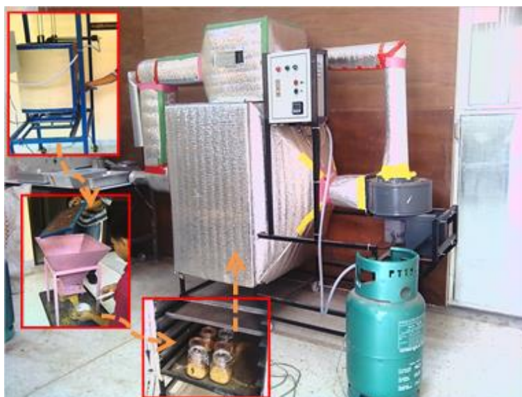
ภาพที่ 5 อุปกรณ์เทมเปอร์ริงข้าวเปลือกในภาชนะอับอากาศและเครื่องอบแห้งด้วยลมร้อน
