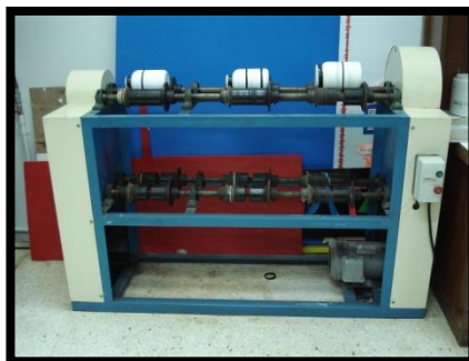
รูปที่ 2.3 การบดผสมแบบเปียกด้วยเครื่อง ball-milling
