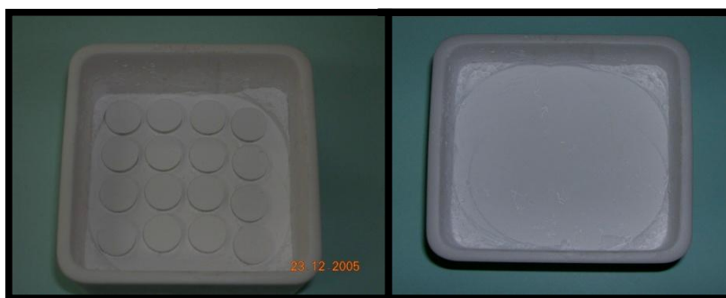
รูปที่ 2.7 การนำชิ้นงานไปวางเรียงในถ้วยอะลูมินาแล้วใช้ผงอะลูมินาวางด้านล่างและกลบด้านบนของชิ้นงาน
