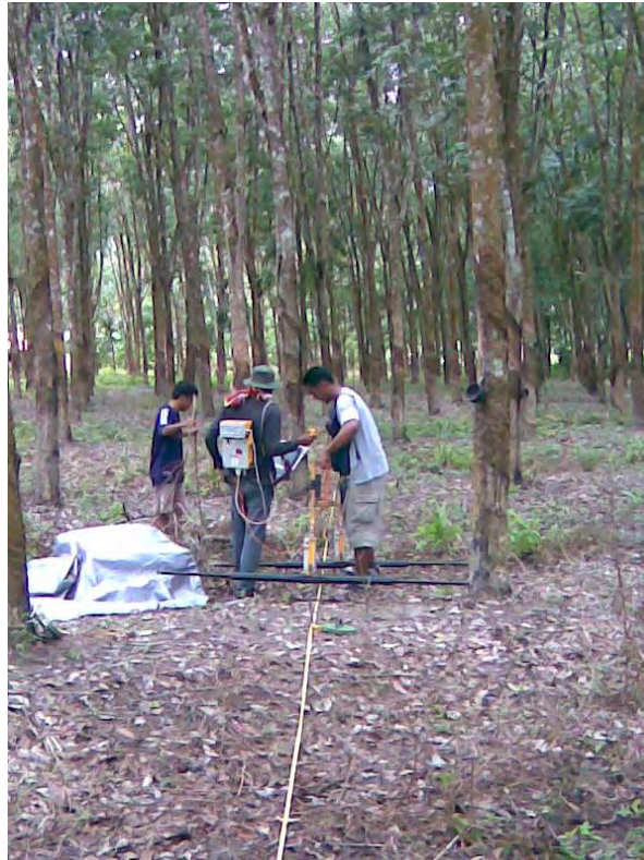
รูปที่ 9 การสำรวจคลื่นเรดาร์หยั่งลึกชั้นดิน ทำการวัดแบบ common offset โดยใช้ชุดสายอากาศความถี่ 50 MHz
