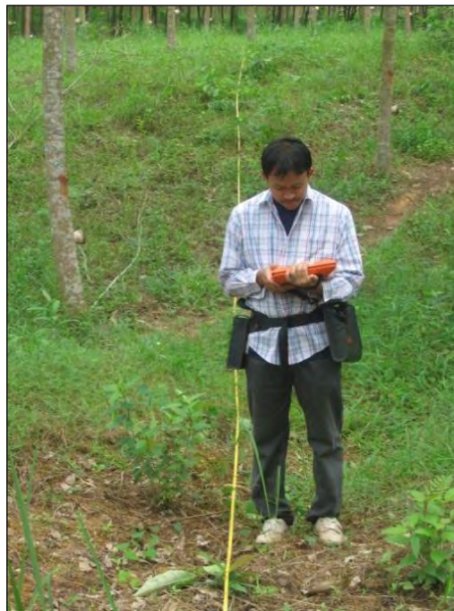
รูปที่ 21 การวัดวิธีแม่เหล็กไฟฟ้าความถี่ต่ำด้วยเครื่อง WADI VLF ในพื้นที่วิจัย
