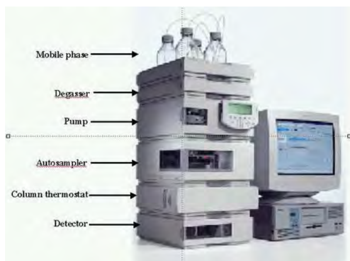
รูปที่ 14 แสดงส่วนประกอบหลักของเครื่อง HPLC
