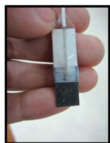
นำมาติดสายไฟและกำหนดพื้นที่ทำงาน
