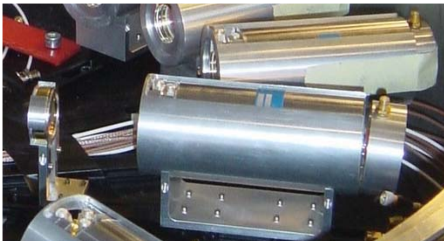
รูปที่ 3.9 ภาพถ่ายของชุดหัววัดแบบโทรทรรศน์ประกอบด้วยหัววัดสารกึ่งตัวนำแบบ Silicon Surface barrier ขนาดบางและหนา และหัววัดสารเรืองแสงแบบซีเซียมไอโอไดต์ (CsI) ที่ยังไม่ได้ต่อสายสัญญาณ โดยแต่ละชุดวางอยู่บนรางที่สามารถเลื่อนให้เข้าใกล้หรือห่างไกลจากเป้าปฏิกิริยาที่จุดศูนย์กลางของอุโมงค์อนุภาค
