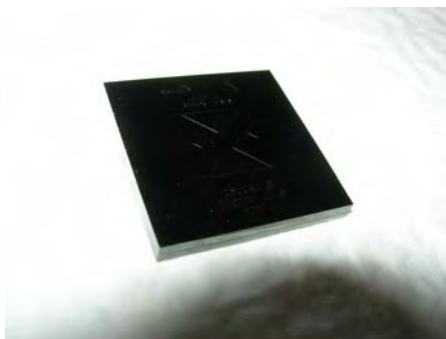
รูป 3-3 ชั้นงานมาตรฐานขนาดความลึก 1.8\ \mu\text{m}
