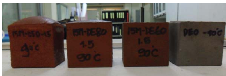
รูปที่ 5.12 ผลกระทบของอุณหภูมิการเร่งปฏิกิริยาต่อจีโอโพลิเมอร์มอร์ตาร์
