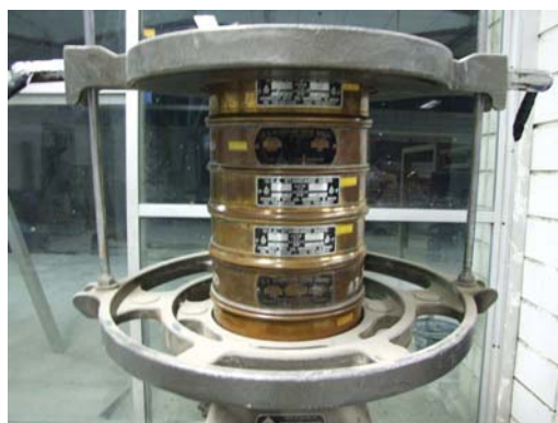
รูปที่ 3.3 การทดสอบการหาขนาดละเอียดของทราย
