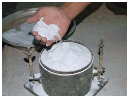
รูปที่ 3.5 การทดสอบหาค่าความถ่วงจำเพาะและหน่วยน้ำหนักของไดอะตอมไมท์และเพอร์ไลท์
