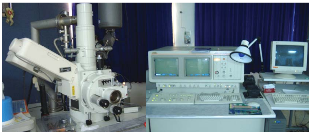
รูปที่ 3.6 เครื่องถ่ายภาพขยายกำลังสูง Scanning Electron Microscope (SEM)
