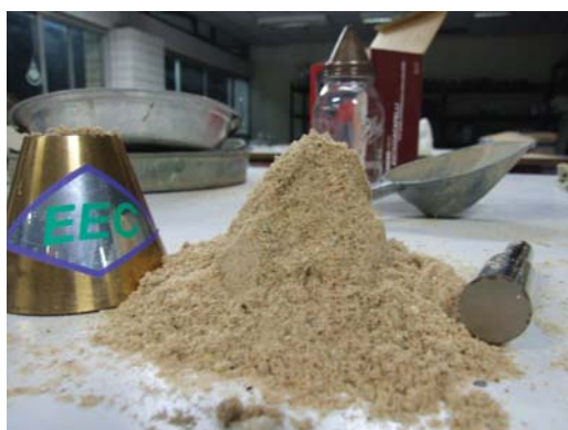
รูปที่ 3.2 การทดสอบหาความถ่วงจำเพาะและค่าการดูดซึมน้ำของทราย
