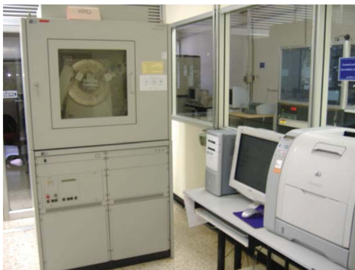
รูปที่ 3.9 เครื่องทดสอบองค์ประกอบทางเคมี X-Ray Diffractometer Analysis (XRD)
