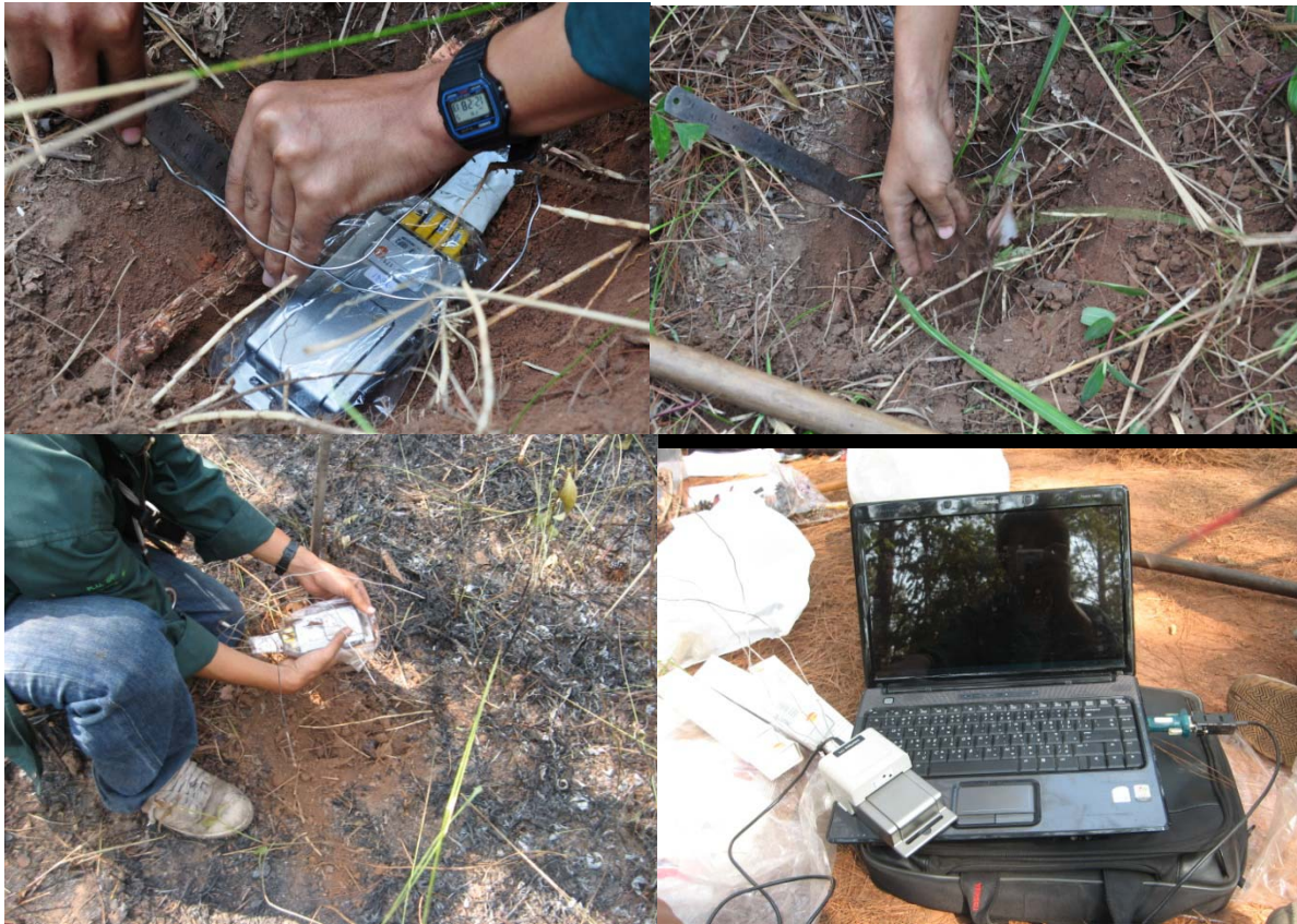
การติดตั้งเครื่องตรวจวัดอุณหภูมิดิน (thermocouple: TESTO-171) โดยการฝังดินก่อนทำการเผาแปลง (2 ภาพบน) และการเก็บอุปกรณ์และถ่ายโอนข้อมูลภายหลังการเผา (2 ภาพล่าง)
