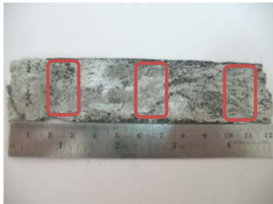
รูปที่ 2 - 2 ชิ้นงานที่ได้หลังจากจุ่มแม่พิมพ์ทองแดง (Copper Quenching Mold) และบริเวณที่ตรวจสอบโครงสร้างจุลภาค
