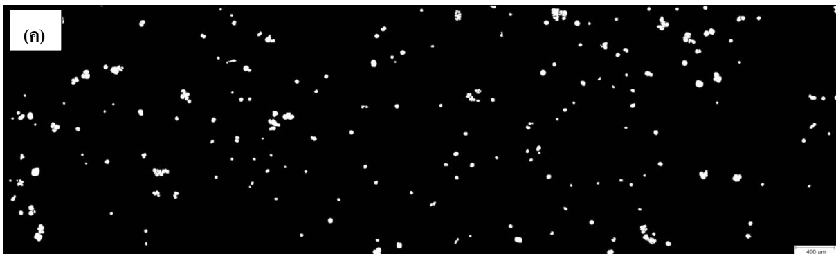
รูปที่ 3 -38แสดงโครงสร้างจุลภาคที่การจุ่มแท่งแกรไฟต์เป็นเวลา 20วินาทีครั้งที่ 2
