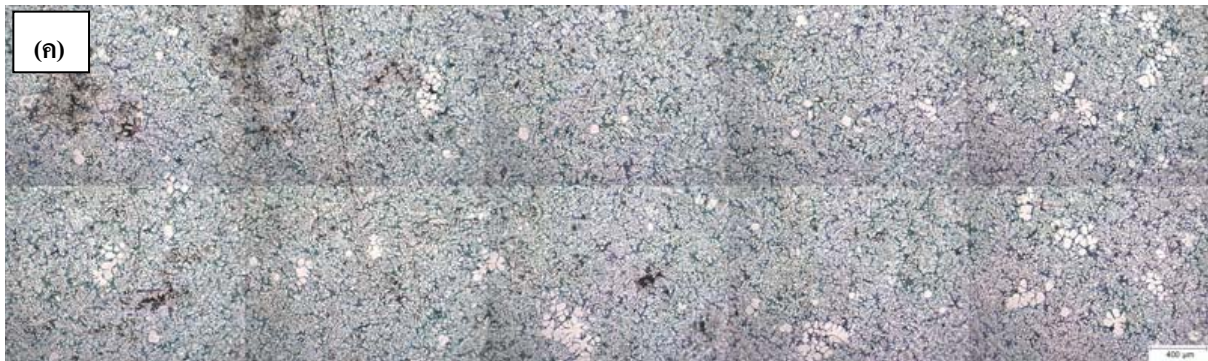
รูปที่ 3 - 65แสดงโครงสร้างจุลภาคที่อุณหภูมิแท่งแกรไฟต์ 200°C จุ่มแท่งแกรไฟต์เป็นเวลา 30วินาที
