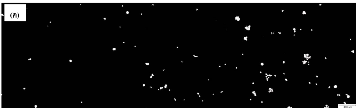
รูปที่ 3 - 68แสดงโครงสร้างจุลภาคที่อุณหภูมิแท่งแกรไฟต์ 100°C จุ่มแท่งแกรไฟต์เป็นเวลา 10วินาที
