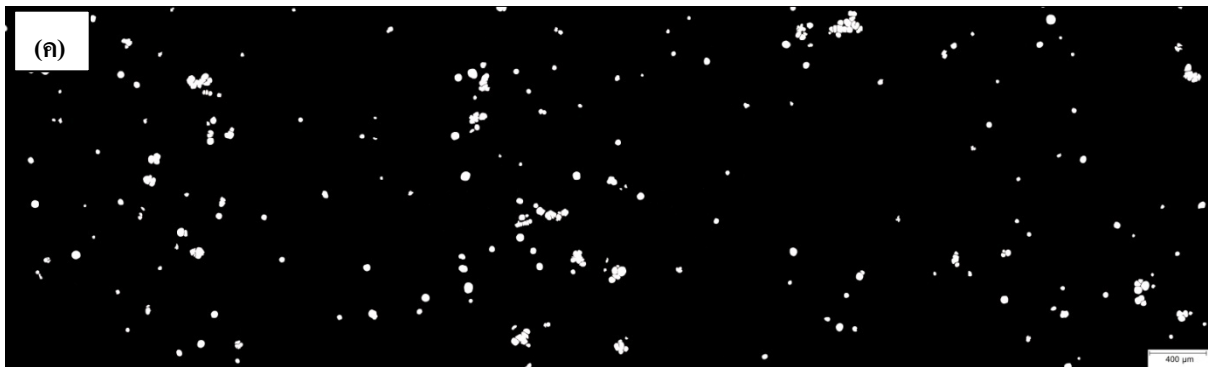
รูปที่ 3 - 73แสดงโครงสร้างจุลภาคที่อุณหภูมิแท่งแกรไฟต์ 200°C จุ่มแท่งแกรไฟต์เป็นเวลา 20วินาที
