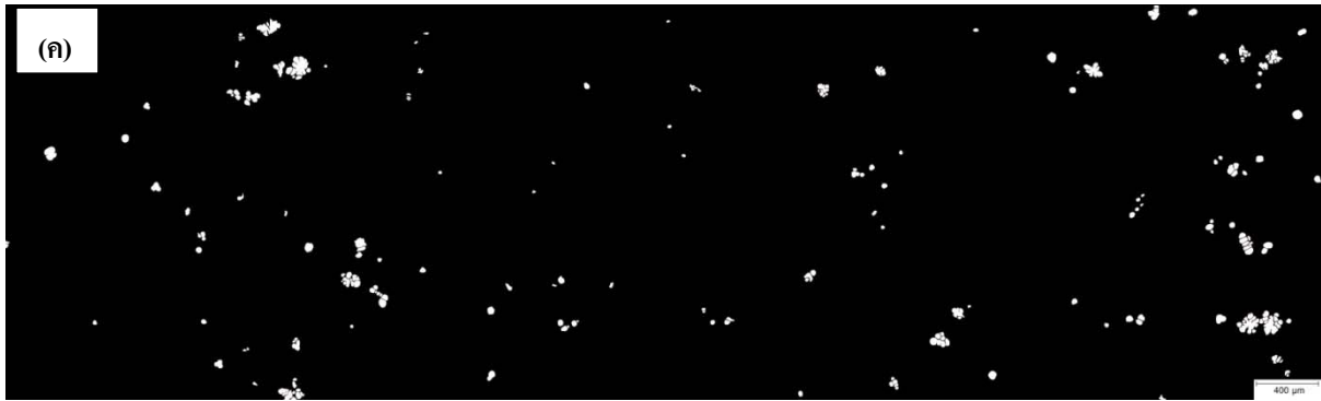
รูปที่ 3 - 89 แสดงโครงสร้างจุลภาคที่มี cooling โดยจุ่มแท่งแกรไฟต์เป็นเวลา 10 วินาที
