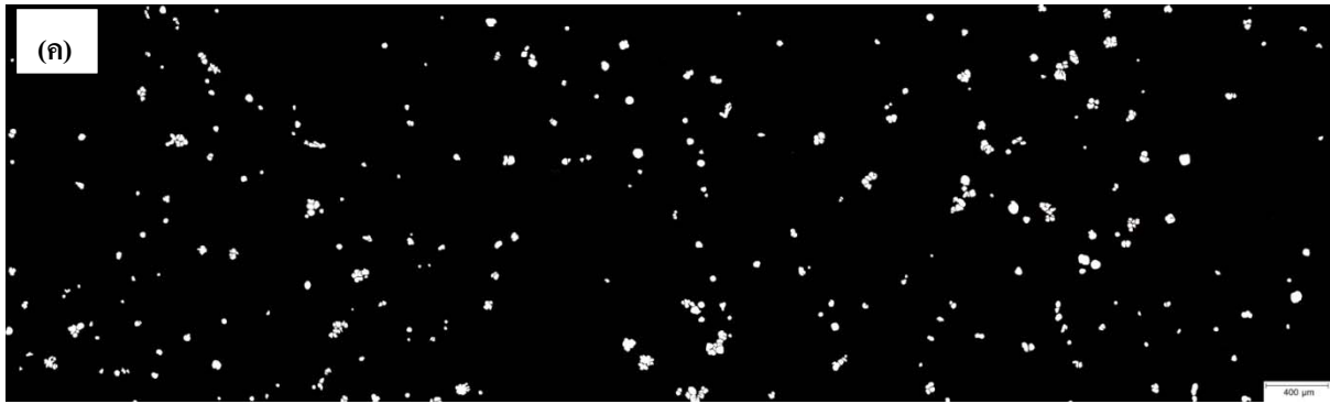
รูปที่ 3 - 70 แสดงโครงสร้างจุลภาคที่อุณหภูมิแท่งแกรไฟต์ 300°C จุ่มแท่งแกรไฟต์เป็นเวลา 10 วินาที
