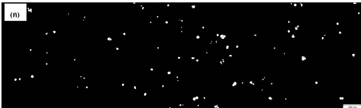
รูปที่ 3 - 75แสดงโครงสร้างจุลภาคที่อุณหภูมิแท่งแกรไฟต์ 400°C จุ่มแท่งแกรไฟต์เป็นเวลา 20วินาที
