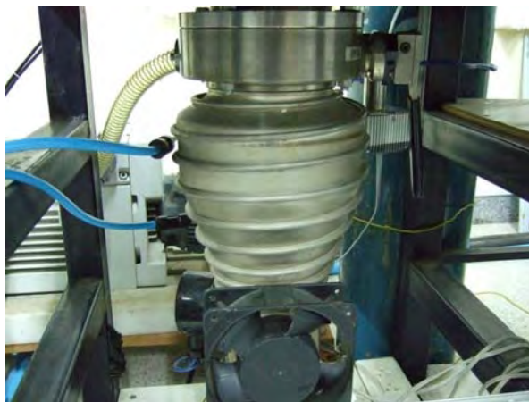
ภาพที่ 28 ปั๊มไอแพร่ (diffusion pump)
