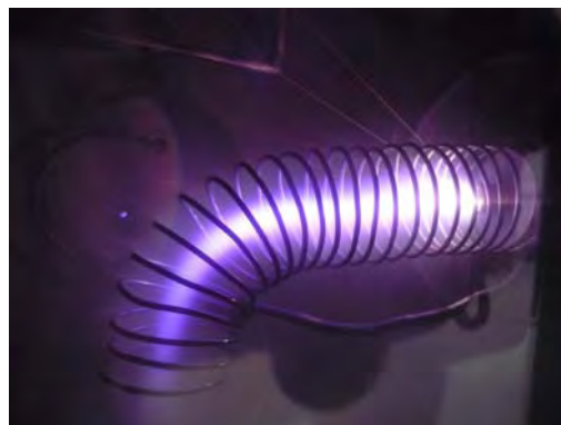
ภาพที่ 33 แสดงการเกิดพลาสมาอาร์คจากการทดสอบหัวกำเนิดพลาสมาอาร์ค
