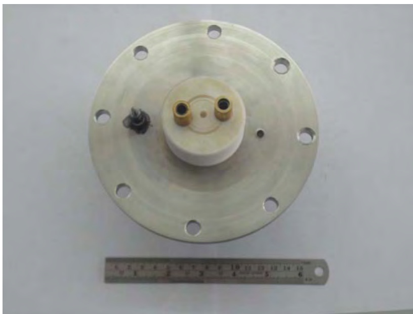
ภาพที่ 14 การติดตั้งขั้วแอโนดเข้ากับ Teflon
