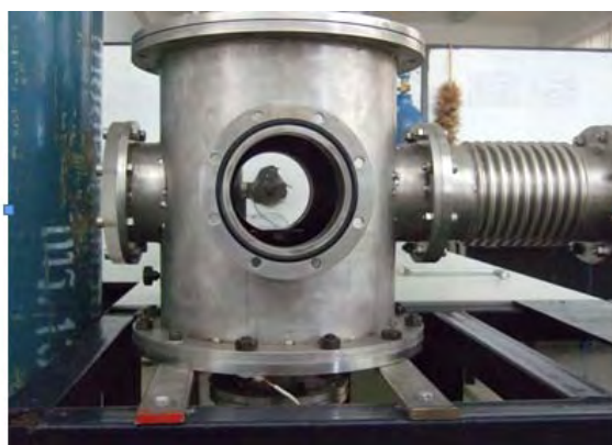
ภาพที่ 26 ห้องสุญญากาศหรือแชมเบอร์สำหรับใส่หัวกำเนิดพลาสมา
