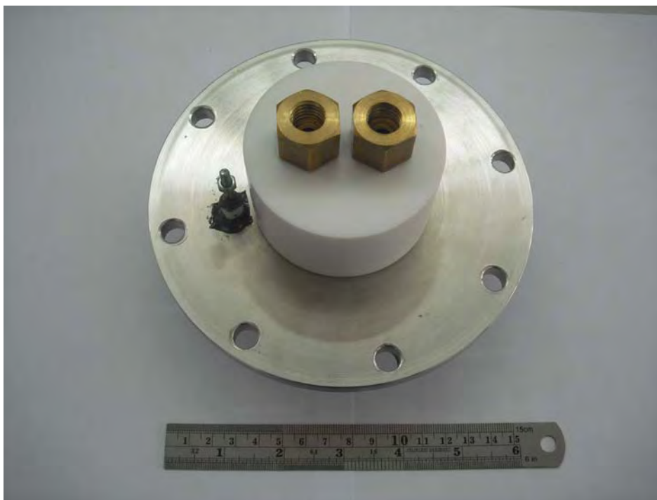
ภาพที่ 13 การติดตั้งเกลียว screw เข้ากับ Teflon
