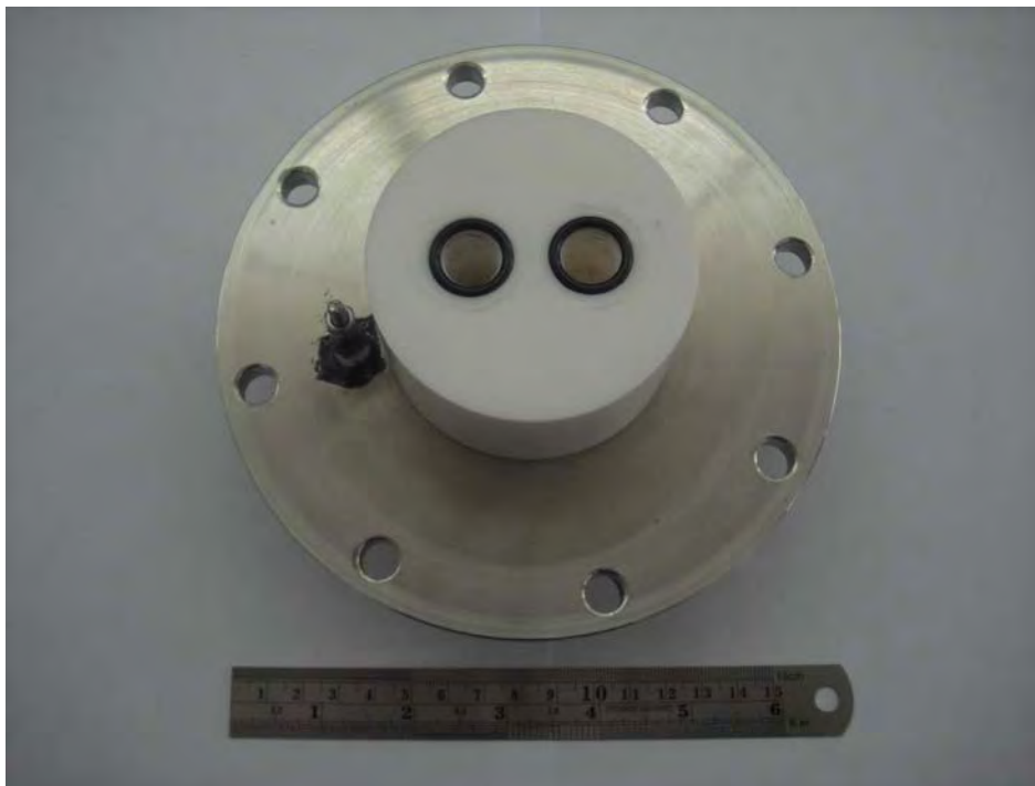
ภาพที่ 12 การติดตั้ง O-Ring เข้ากับ Teflon
