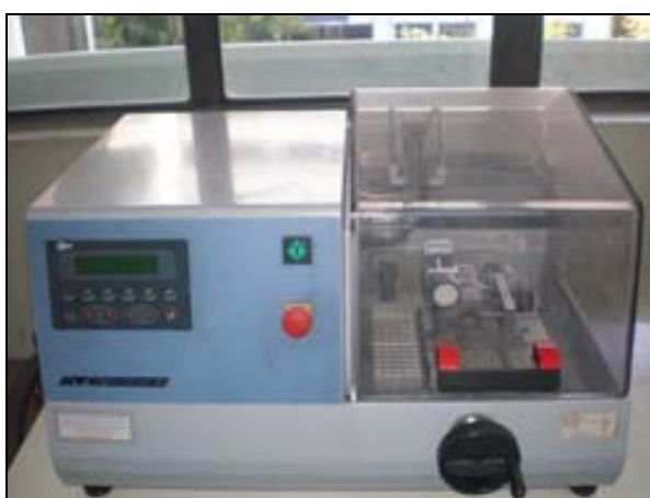
รูปที่ 10 เครื่องตัดชิ้นงานที่มีความเที่ยงตรงสูง ยี่ห้อ ATM Brilliant รุ่น 221
