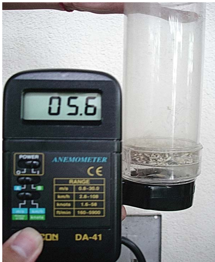
รูปที่ 3 แสดงการวัดความเร็วลมวิกฤตของก้อนข้าวรา
