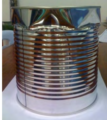
รูปที่ 2.7 การเสียรูปของกระป๋องจากการรับแรงในแนวแกน
