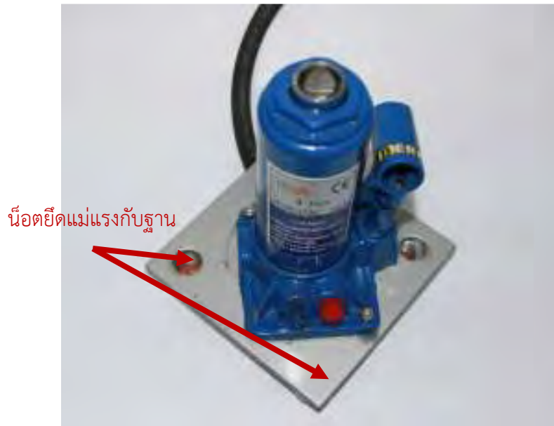
รูปที่ 10 แสดงการติดตั้งแม่แรงลงบนฐานรอง
