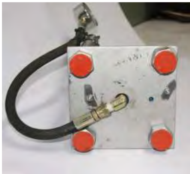
รูปที่ 11 แสดงการติดตั้ง Pressure gage
