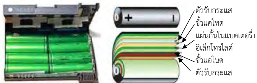
ภาพที่ 2.7 ภาพแสดงส่วนประกอบของแบตเตอรี่ชนิดลิเทียมไอออน [7]
