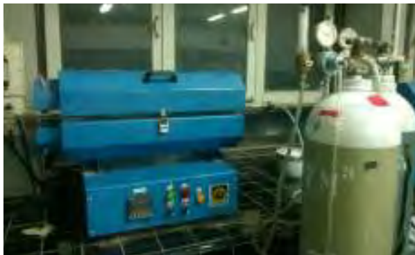
ภาพที่ 3.2 เตาเผาภายใต้บรรยากาศอาร์กอน
