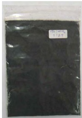
รูป 3.3 พอลิทีโอฟินโดปด้วยกรดเปอร์คลอริกที่อัตราส่วนการโดป N_M/N_A เท่ากับ 1:2.5
