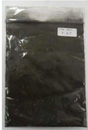
รูป 3.2 พอลิทีโอฟินโดปด้วยกรดไฮโดรคลอริกที่อัตราส่วนการโดป N_M/N_A เท่ากับ 1:2.5
