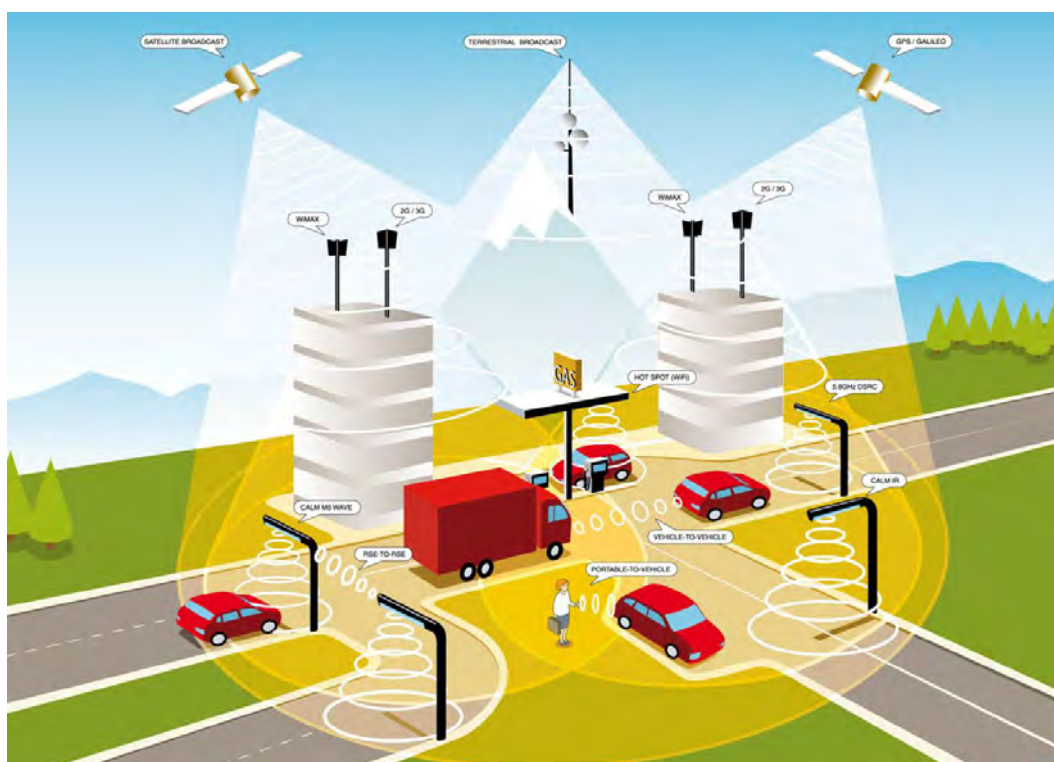
รูปที่ 1-1 ลักษณะการสื่อสารบนเครือข่ายไร้สายแบบแอดฮอคสำหรับยานพาหนะ[2]
