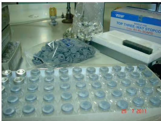
รูปที่ 2.10 ปกรณการเก็บตัวอย่างก๊าซ
