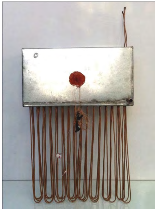
รูปที่ 3.8 สายเทอร์โมคัปเปิลที่ร้อยผ่านกล่องสังกะสี
