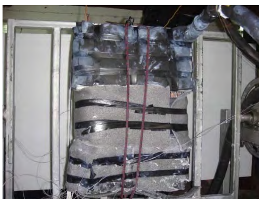
รูปที่ 3.17 ชุดท่อความร้อนพร้อมทดลอง
