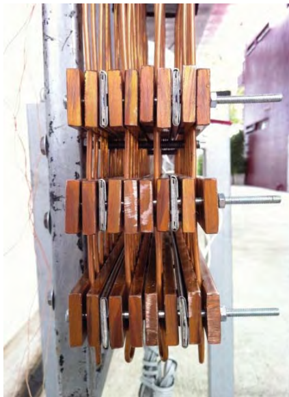
รูปที่ 3.13 การประกบฮีตเตอร์ไฟฟ้าและแผ่นทองแดงแบนเข้าด้วยกันกับแผงท่อคาปิลลารีทองแดง
