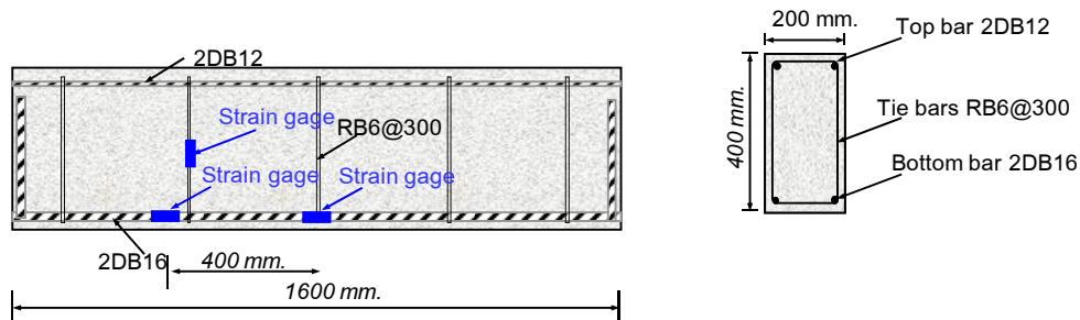
รูป 2.2.1 รายละเอียดการเสริมเหล็กของชุดคานคอนกรีต (FD, FS และ FB)
