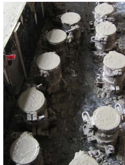
รูป 3.5 เก็บลูกปูนเพื่อทดสอบ และ ทดสอบค่าการยุบตัว
