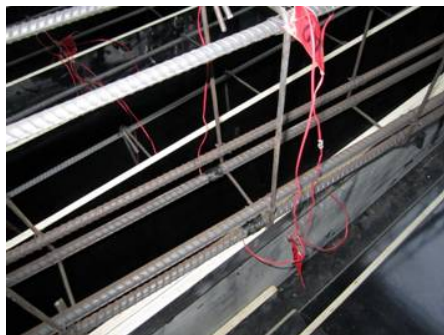
รูป 1.0.4 ทำการติด Stain Gage ในตำแหน่งที่ต้องการ
