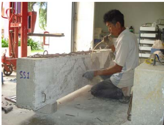
รูป 3.8 การซ่อมแซมคานเหล็กโดยการเสริมแผ่นเฟอร์โรซีเมนต์ด้านข้างคานเหล็ก
