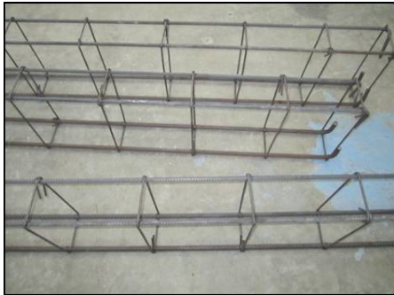
รูป 1.0.1 แสดงการจัดวางเหล็กของคานชุดแรกวิบัติภายใต้แรงดัด (FB0, FB1, FB2)
