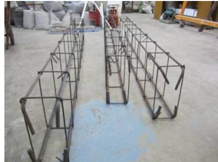
รูป 1.0.1 แสดงการจัดวางเหล็กของคานชุดแรกวิบัติภายใต้แรงดัด (FB0, FB1, FB2)
