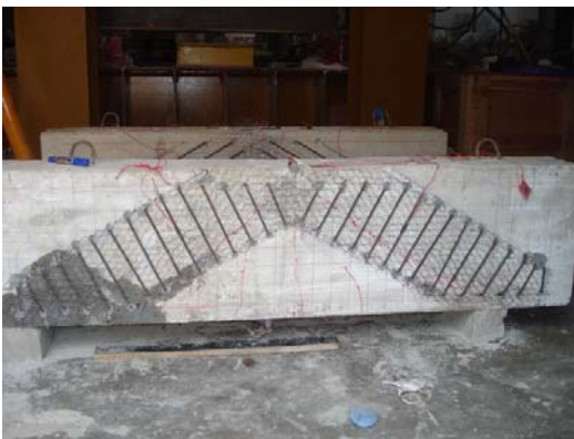
รูป 3.12 การซ่อมแซมคานเหล็กเมื่อคานลึกวิบัติภายใต้แรงเฉือนร่วมอัดโดยการเสริมแผ่นเฟอร์โรซีเมนต์
