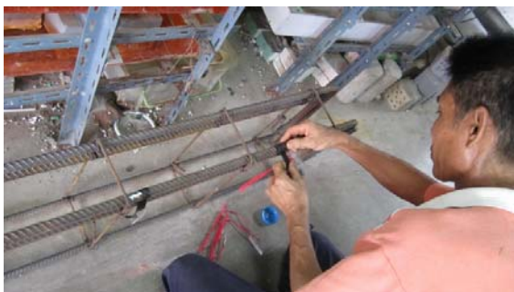
รูป 3.6 ทำการติด Stain Gage ในตำแหน่งที่ต้องการ
