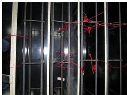
รูป 1.0.4 ทำการติด Stain Gage ในตำแหน่งที่ต้องการ
