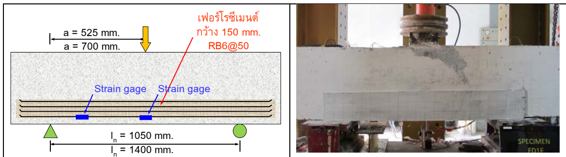
(ค) การซ่อมแซมชิ้นทดสอบ FS1, FD1 โดยการจัดวางแถบเฟอรโรซีเมนต์แนวนอนแนบข้างคาน
