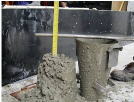
รูป 1.0.6 ทดสอบค่าการยุบตัว และเก็บลูกปูนเพื่อทดสอบ
