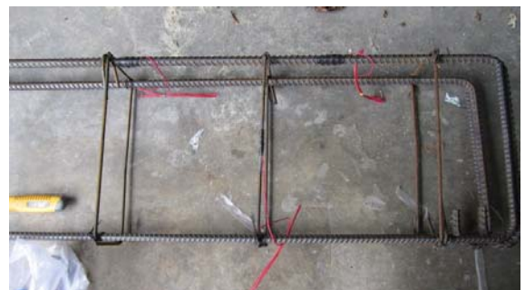
รูป 3.6 ทำการติด Stain Gage ในตำแหน่งที่ต้องการ
