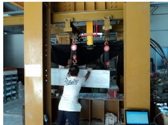
รูป 3.13 การติดตั้งคานลึกคอนกรีต และอุปกรณ์ทดสอบ
