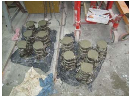
รูป 1.0.6 ทดสอบค่าการยุบตัว และเก็บลูกปูนเพื่อทดสอบ
