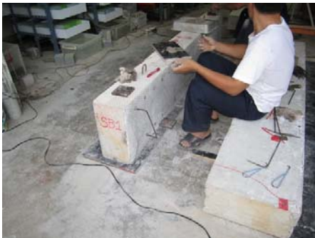
รูป 1.0.7 การซ่อมแซมคานเมื่อคานวิบัติภายใต้แรงเฉือน โดยการเสริมแผ่นเฟอร์โรซีเมนต์ด้านข้างคาน
