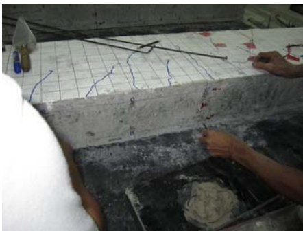
รูป 1.0.9 การซ่อมแซมคานเมื่อคานวิบัติภายใต้แรงดัด โดยการเสริมแผ่นเฟอร์โรซีเมนต์ที่ท้องคาน
