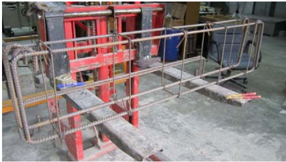
รูป 3.3 การจัดวางเหล็กของคานลิกซูดที่ 2 วิวติภายใต้แรงเฉือนร่วมดิ่ง (FDB1, FD2, FS1, FS2)
