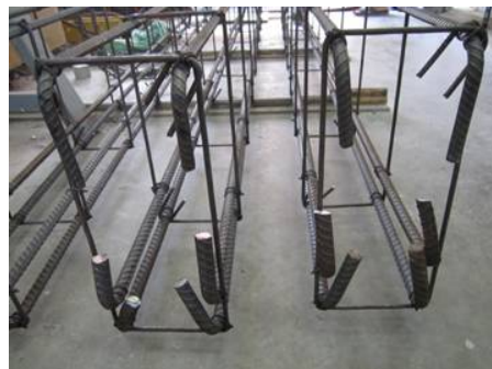
รูป 1.0.2 การจัดวางเหล็กของคานชุดสองวิบัติภายใต้แรงเฉือน (SB0, SB1, SB2)
