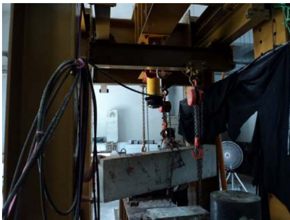
รูป 3.13 การติดตั้งคานลึกคอนกรีต และอุปกรณ์ทดสอบ
