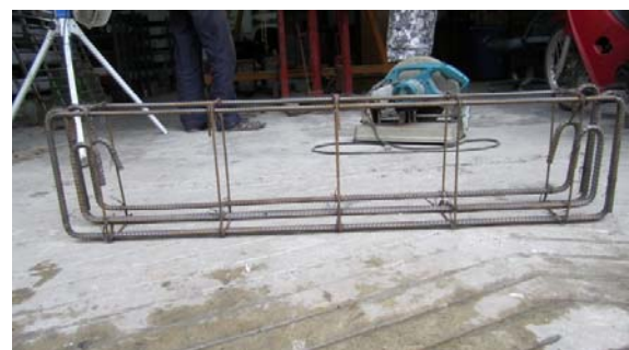
รูป 3.2 การจัดวางเหล็กของคานเหล็กชุดที่ 1 วิทยุภายใต้แรงเฉือนร่วมอัด (SD1, SD2, SD3, SS1, SS2, SS3)
