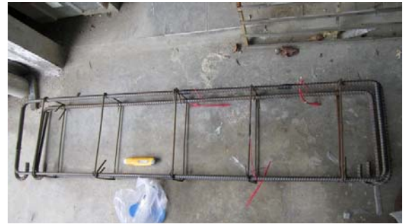
รูป 3.3 การจัดวางเหล็กของคานลิกซูดที่ 2 วิวติภายใต้แรงเฉือนร่วมดิ่ง (FDB1, FD2, FS1, FS2)
