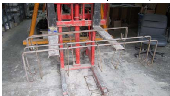
รูป 3.2 การจัดวางเหล็กของคานเหล็กชุดที่ 1 วิทยุภายใต้แรงเฉือนร่วมอัด (SD1, SD2, SD3, SS1, SS2, SS3)
