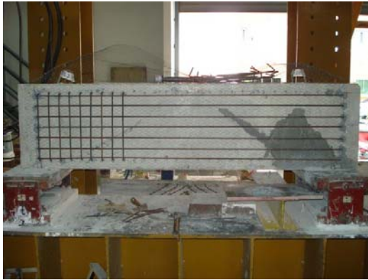
รูป 3.11 โดยการจัดวางแถบเฟอร์โรซีเมนต์ทั้งแนวนอนและแนวตั้ง SD3F, SS3F
