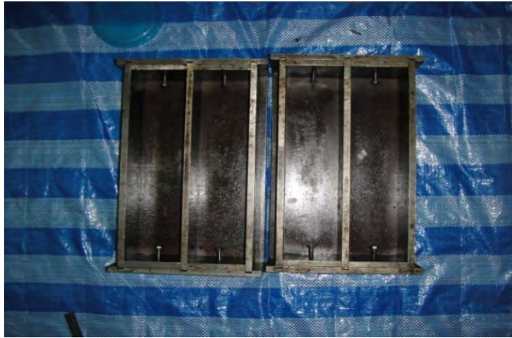
รูปที่ 3.8 แบบหล่อคอนกรีตขนาด 7.5x7.5x28.5 ซม.
