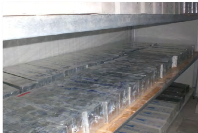
รูปที่ 3.26 การเก็บก้อนตัวอย่างคอนกรีต เพื่อวัดการหดตัวแบบออโตจีนิส
