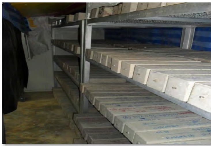
รูปที่ 3.27 การเก็บก้อนตัวอย่างคอนกรีต เพื่อวัดการหดตัวแบบออโตจีนิส
