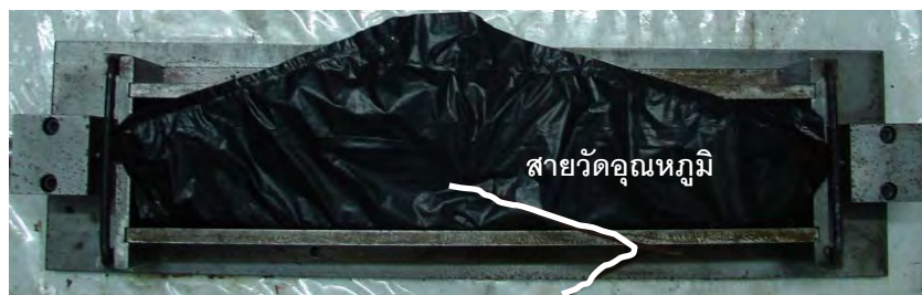
รูปที่ 3.19 การวัดอุณหภูมิภายในคอนกรีต
