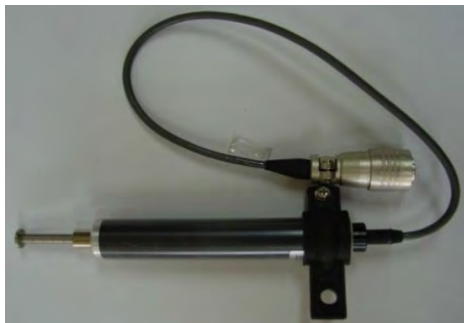
รูปที่ 3.13 เครื่องวัดการเปลี่ยนแปลงความยาวในแนวราบ (LVDT)
