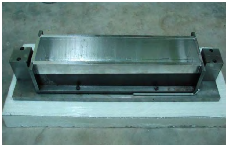
รูปที่ 3.9 แบบหล่อคอนกรีตขนาด 7.5x7.5x40.0 ซม.
