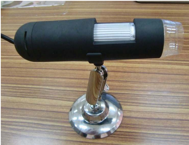
รูปที่ 12. กล้อง VDO ที่ใช้ในการบันทึกภาพเพื่อตรวจวัดปริมาณการบวมตัวแบบ Diameter Swell
