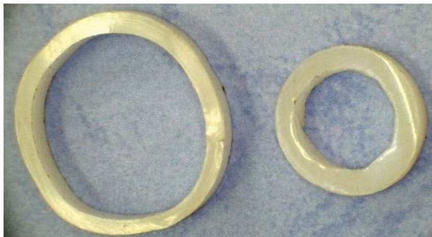
รูปที่ 13. ตัวอย่างชิ้นงานตัดจากชิ้นงานจริงตามกำหนดด้วยเวลาของการอัดรีดอัดรีดเพื่อตรวจวัดปริมาณการบวมตัวแบบ Thickness Swell
