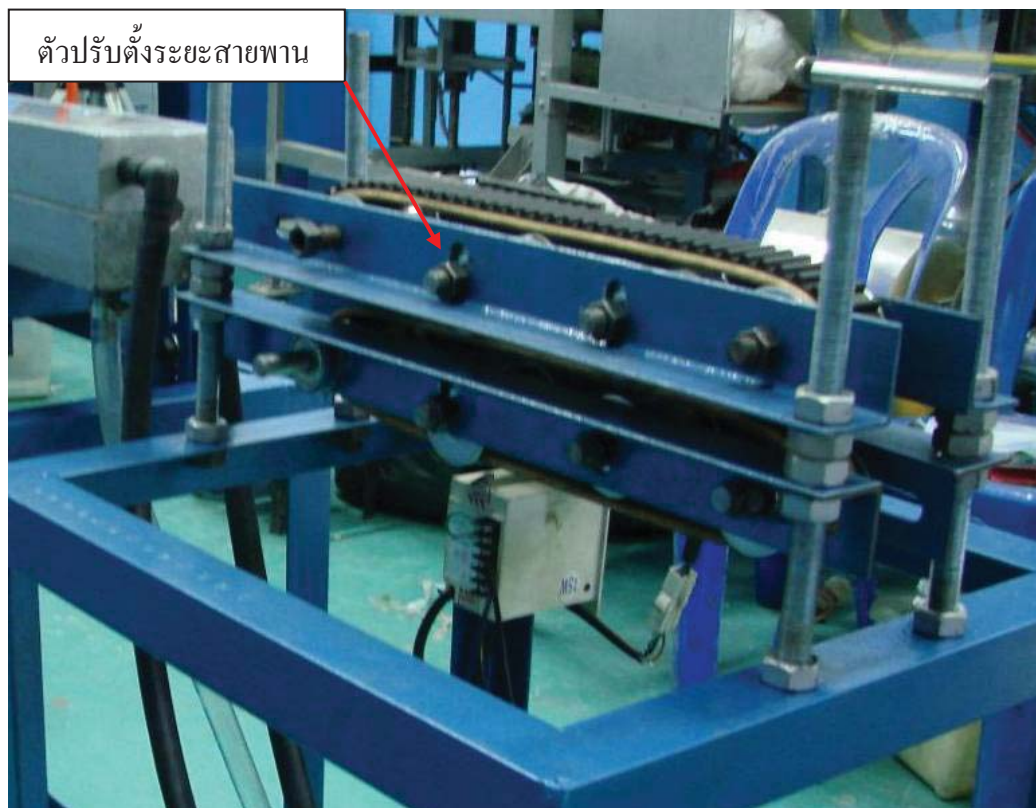
รูปที่10 แสดงส่วนประกอบของชุดสายพานลำเลียงชิ้นงาน
