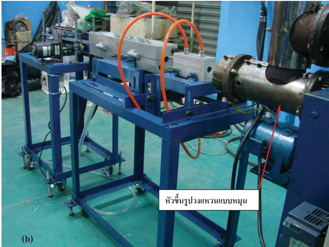
รูปที่ 1. ภาพรวมของระบบลำเลียงท่อ ชุดหล่อเย็น และ Sizing ที่ประกอบเข้าต่อเนื่องจากหัวขึ้นรูปแบบหมุนและเครื่องอัดรีดแบบเกลียวหนอนเดี่ยว
