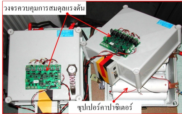
ภาพที่ 1-27 ซูเปอร์คาปาซิเตอร์ของบริษัท SAFT โมดูลขนาดเล็ก 12 ตัว ต่ออนุกรมกัน
