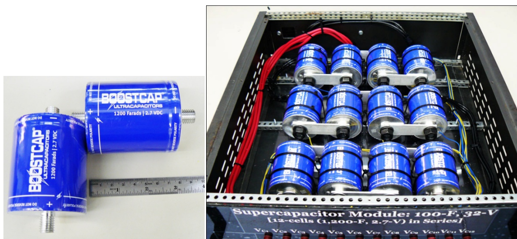
ภาพที่ 1-29 ซูเปอร์คาปาซิเตอร์ของบริษัท Maxwell (เรียกว่า Booscap) 1 เซลล์ และโมดูลที่ BCAP1200 ต่ออนุกรมกัน 12 ตัว
