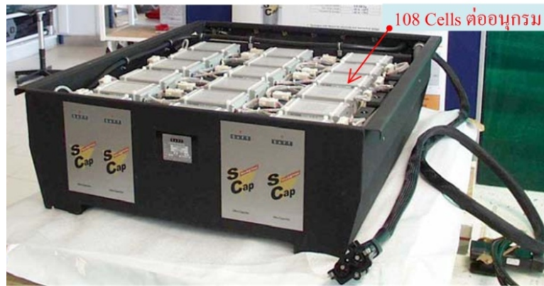
ภาพที่ 1-28 ซูเปอร์คาปาซิเตอร์ของบริษัท SAFT โมดูลขนาดใหญ่ 108 ตัว ต่ออนุกรมกัน
