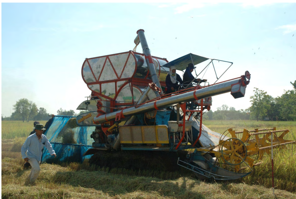
ภาพที่ 1 การเก็บตัวอย่างความสูญเสียจากชุดนวดของเครื่องเกี่ยวนวดข้าว
