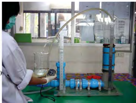
รูปที่ 3.5 แสดงชุดทดสอบค่าความซึมน้ำของคอนกรีตพรุน
