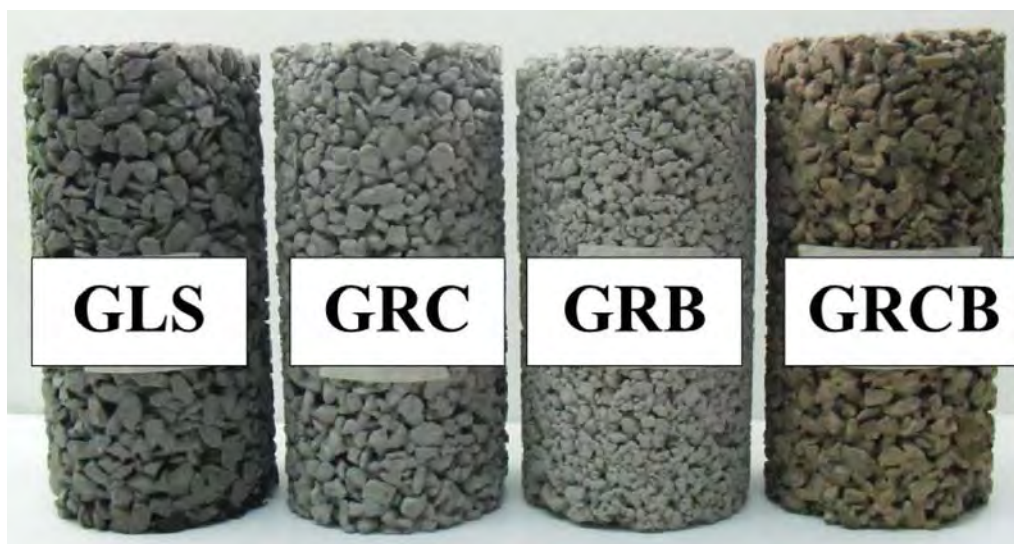
รูปที่ 3.3 ตัวอย่างคอนกรีตพูนที่ใช้โพลิเมอร์เพสต์เป็นวัสดุประสาน
