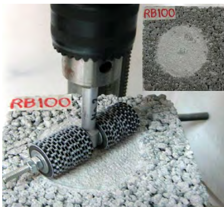
รูปที่ 3.6 แสดงเครื่องมือและการทดสอบการสึกกร่อนของผิวหน้า
