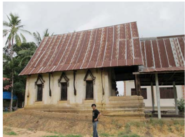
รูปที่ 3.79 ตัวอย่างแบบผังพื้นมีมุขหน้า ฐาน ลูกแก้วอกไก่ และช่วงเสา 3 ช่วง ที่รูปแบบสิมณวนสืบทอดและ พัฒนาทางงานช่าง เป็นต้น ที่วัดได้ยั้งขึ้นก อ.เซียงใน จังหวัดอุบลราชธานี
