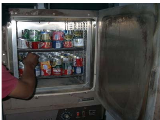
รูปที่ 3.3 การอบหาค่าความชื้นเริ่มต้น
