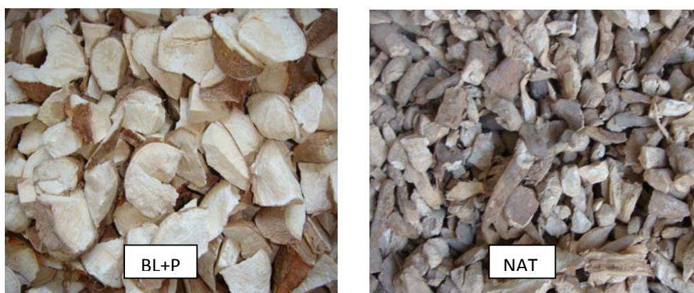
รูปที่ 4.17 ตัวอย่างมันสำปะหลังเส้นที่ผ่านการพรีทรีทเมนต์
