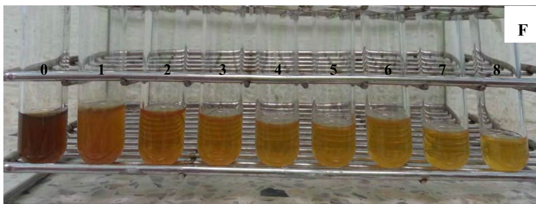
รูปที่ 4.22 การเปลี่ยนแปลงสีของน้ำทิ้งโรงงานสกัดน้ำมันปาล์มที่ผ่านการบำบัดขั้นต้นด้วยแบคทีเรียย่อยสลายฟีนอลที่ระยะเวลา 4 ชม. (A), 8 ชม. (B) , 24 ชม. (C), 48 ชม. (D), 72 ชม. (E) และบำบัดต่อด้วยราไทรออสายพันธุ์ Trametes hirsuta AK4 ที่ตรึงบนเส้นใยปาล์มน้ำมัน เปรียบเทียบกับน้ำทิ้งที่ไม่ผ่านการบำบัด (F) เมื่อบ่มเป็นระยะเวลา 0-8 วัน
