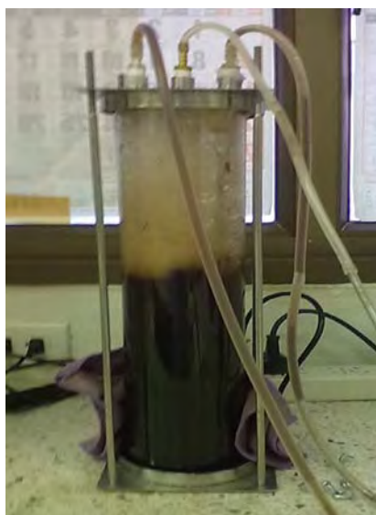
รูปที่ 4.26 ระบบตัวกรองชีวภาพที่บรรจุเซลล์ตรึงและน้ำทิ้งของโรงงานสกัดน้ำมันปาล์ม
