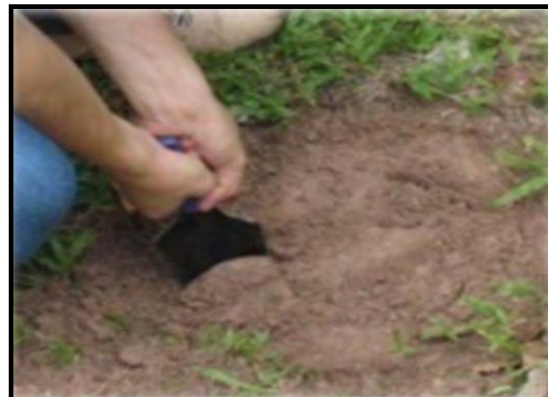
รูปที่ 6.3 การเก็บตัวอย่างดินแบบแปรสภาพในพื้นที่ศึกษา
