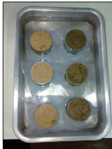
รูปที่ 6.20 เครื่อง Pressure chamber และตัวอย่างแท่งดินที่แช่น้ำเพื่อให้ดินอิ่มตัว
