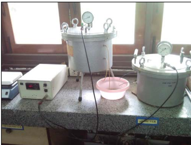
รูปที่ 6.20 เครื่อง Pressure chamber และตัวอย่างแท่งดินที่แช่น้ำเพื่อให้ดินอิ่มตัว
