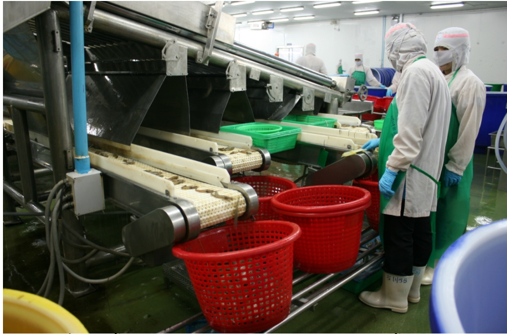
รูปที่ 2.10 ขั้นตอนที่ 3 กุ้งหลังจากผ่านการล้างด้วยคลอรีนครั้งที่สอง (F3)
