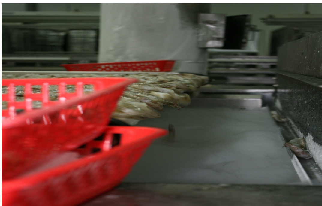
รูปที่ 2.12 ขั้นตอนที่ 5 กุ้งหลังจากการล้างด้วยคลอรีนครั้งที่สาม (F5)
