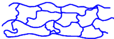
รูปที่ 2.3 โครงสร้างของพอลิเมอร์แบบร่างแห
