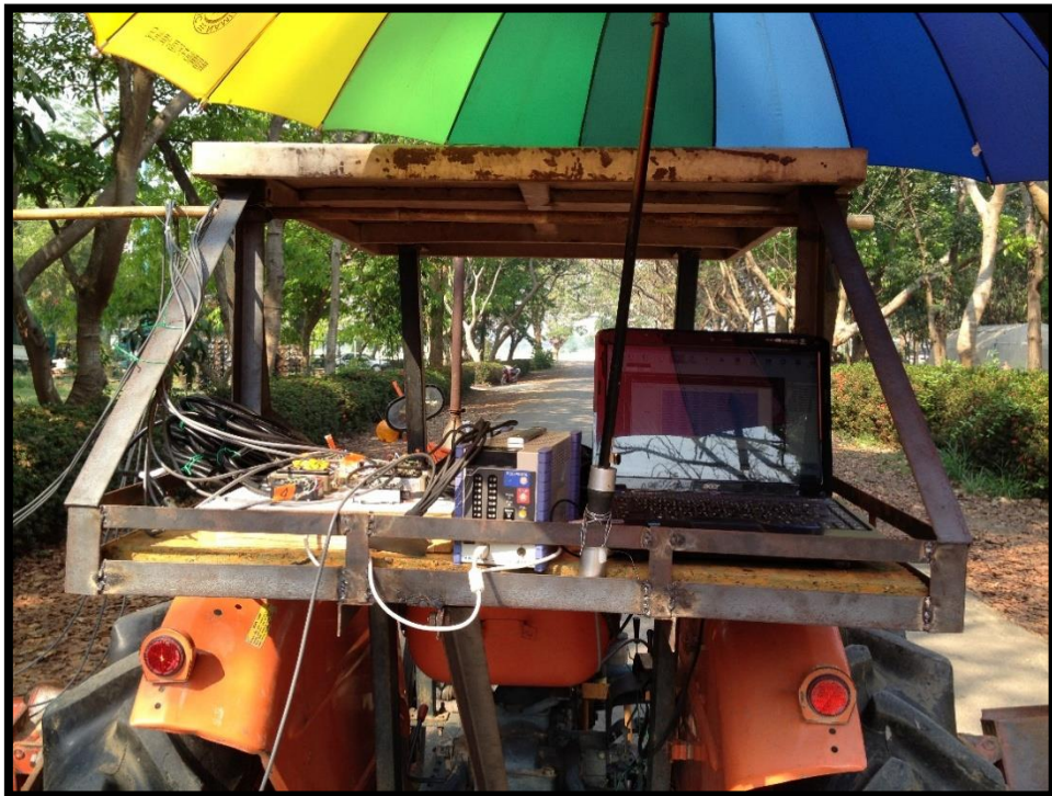
ภาพผนวกที่ ข3 การติดตั้งเครื่องบันทึกข้อมูลเอนกประสงค์ และคอมพิวเตอร์บริเวณหลังรถแทรกเตอร์
