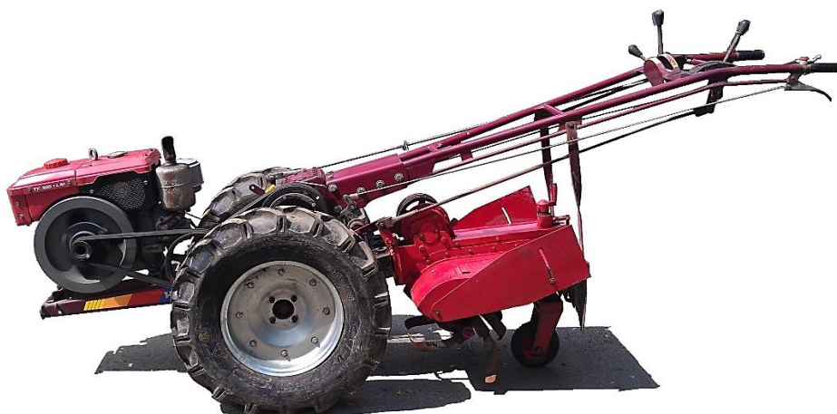
ภาพที่ 25 รถไถเดินตามติดตั้งเครื่องพรวนจอบหมุน
