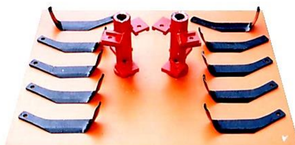
ภาพที่ 26 ไบมีดจอบหมุนที่ใช้ในการทดลองเงื่อนไขไถพรวนดิน
