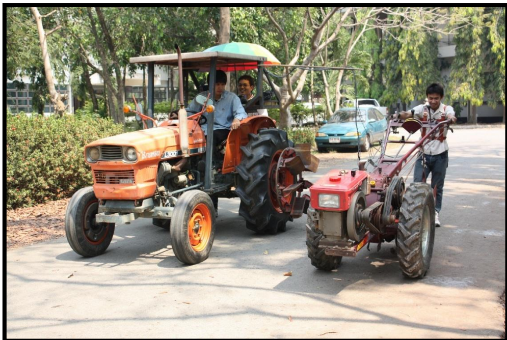
ภาพผนวกที่ ข4 การทดลองเงื่อนไขไรต์ไถเดินตามเคลื่อนที่บนถนนลาดยาง
