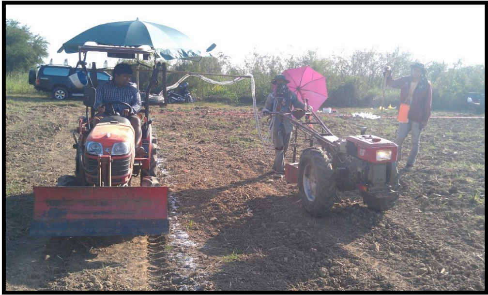
ภาพผนวกที่ ข5 การทดลองเงื่อนไขไรถไถเดินตามเคลื่อนที่บนแปลงเกษตรกรรม
