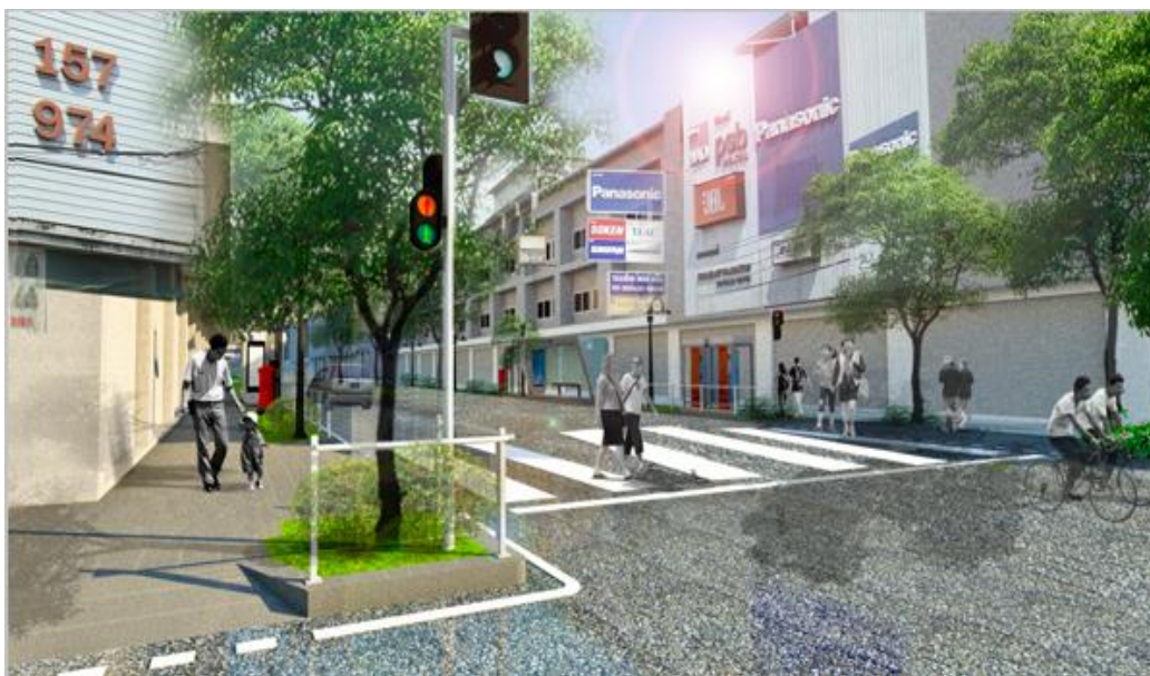
รูปที่ 5.3 แนวทางการปรับปรุงบริเวณทางข้ามให้มีทางลาดเพื่อลดความต่างระหว่างระดับทางผิวถนนและทางเท้าและมีสัญญาณไฟข้าม
