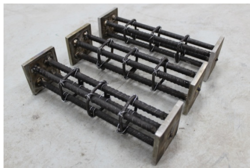
รูปที่ ค2 การเสริมเหล็ก 4-RB9 และ 4-DB12 ภายในคอนกรีต
