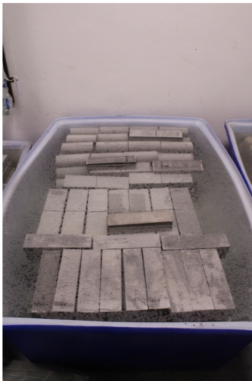
รูปที่ ง7 การบ่มตัวอย่างคอนกรีตในน้ำที่อุณหภูมิห้องเป็นเวลา 28 วัน
