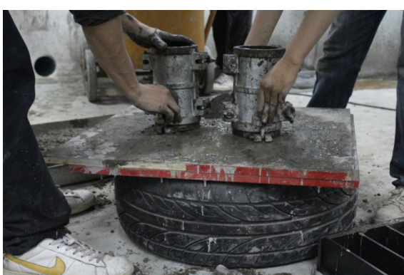
รูปที่ ง6 การเขย่าคอนกรีตด้วยโต๊ะเขย่า
