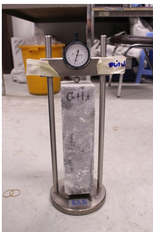
รูปที่ ค6 การวัดค่าการขยายตัวของแท่งคอนกรีตด้วย Comparator
