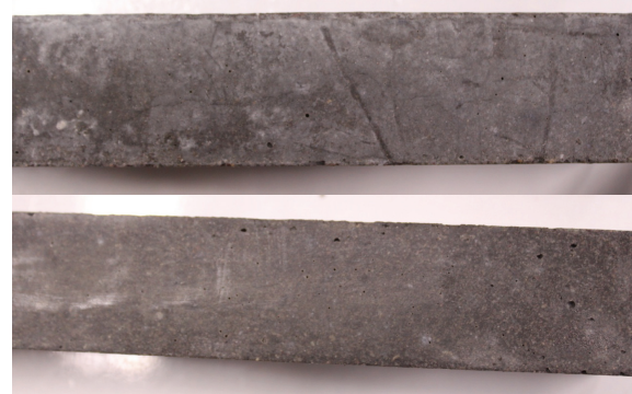
รูปที่ 3 (ต่อ) ลักษณะการแตกร้าวของแท่งมอร์ตาร์ที่ความเข้มข้นของแอลคาไลที่ 1, 2, 3 และ 5 M
