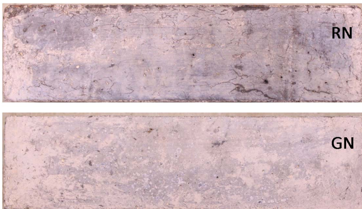
รูปที่ 4-7 รอยร้าวที่ผิวของคอนกรีตจากหินไรโอไลต์และหินแกรนิตที่แช่ใน NaOH
