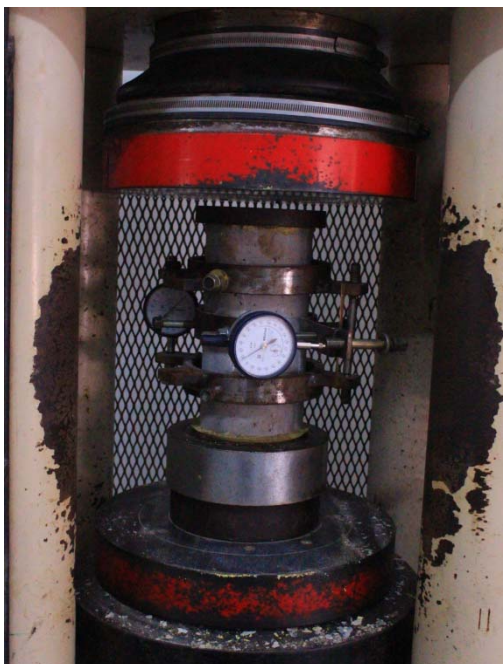
รูปที่ จ2 การติดตั้งอุปกรณ์กับเครื่องทดสอบ Universal Testing Machine (UTM)
