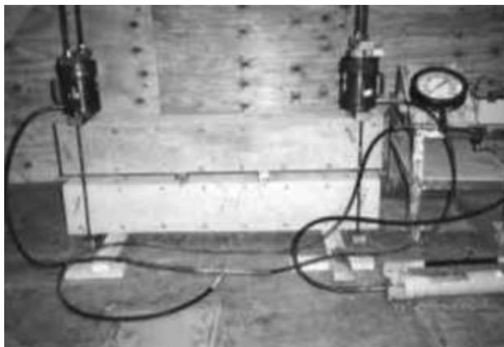
รูปที่ 2-9 การติดตั้งเครื่องมือการทดสอบกำลังดัดของคาน (Fan, S. and Hanson, J.M. 1998)
