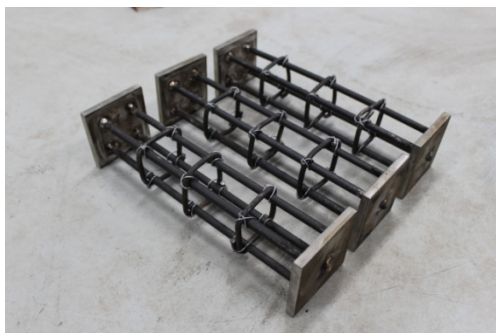
รูปที่ ค2 การเสริมเหล็ก 4-RB9 และ 4-DB12 ภายในคอนกรีต
