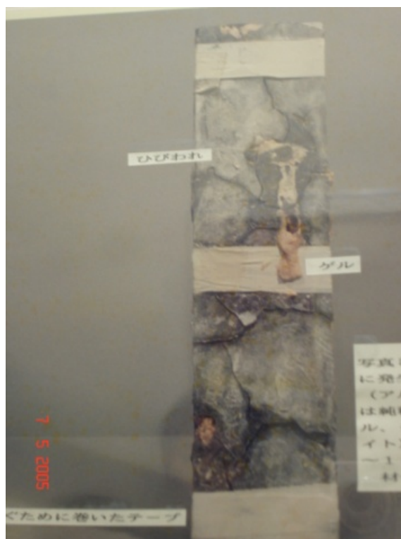
รูปที่ 1-1 ลักษณะการเกิด ASR ในแท่งตัวอย่างทดสอบ
