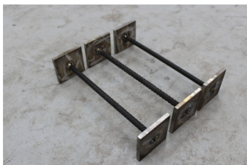
รูปที่ ค1 การเสริมเหล็ก 1-RB9, 1-DB12 และ 1-DB16 ภายในคอนกรีต
