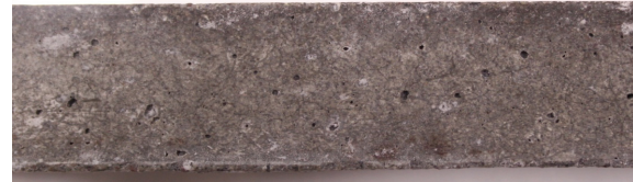
รูปที่ 3 ลักษณะการแตกร้าวของแท่งมอร์ตาร์ที่ความเข้มข้นของแอลคาไลที่ 1, 2, 3 และ 5 M
