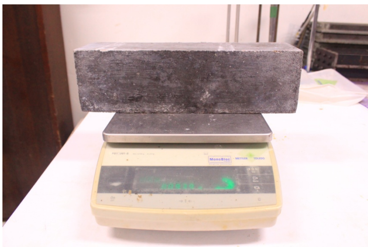
รูปที่ จ2 การชั่งน้ำหนักของตัวอย่างคอนกรีต
