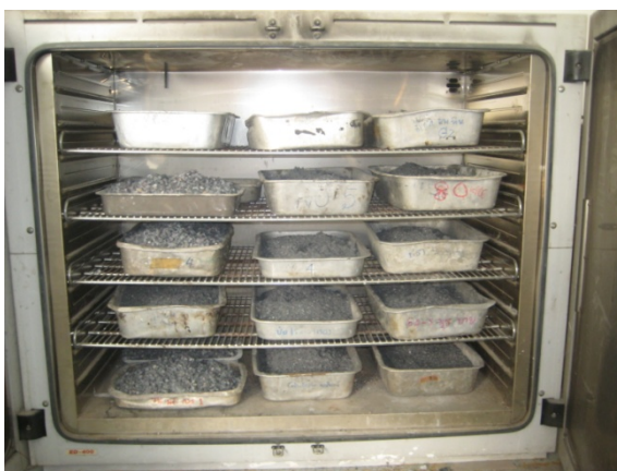
รูปที่ ง2 การอบมวลรวมในตู้อบที่อุณหภูมิ 105 องศาเซลเซียส
