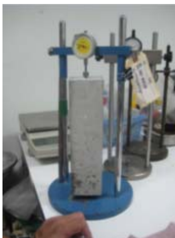
รูปที่ 3-6 การวัดการขยายตัวของคอนกรีตปริซึมด้วยเครื่อง Length Comparator
