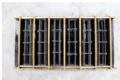
รูปที่ ค3 แบบหล่อแท่งคอนกรีตขนาด 7.5x7.5x28.5 เซนติเมตร
