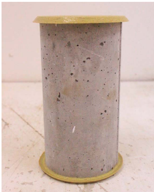
รูปที่ จ1 การ Cap ผิวกดของก้อนตัวอย่างด้วยก้ำมะถัน
