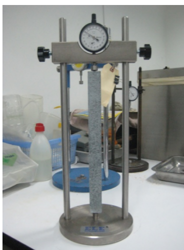
รูปที่ ข3 การวัดการขยายตัวด้วยเครื่อง Length Comparator
