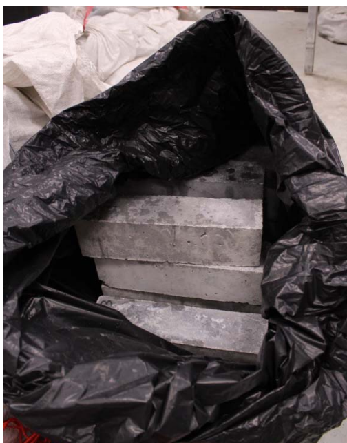
รูปที่ ค5 การป้องกันการสูญเสียความชื้นหลังจากนำออกจากน้ำร้อน
