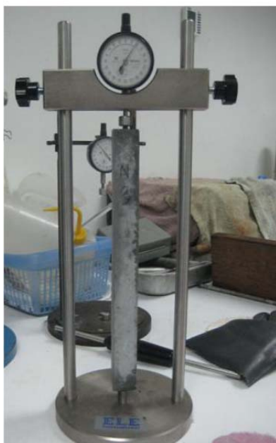
รูปที่ 3-2 การวัดการขยายตัวของแท่ง Mortar ด้วยเครื่อง Length Comparator
