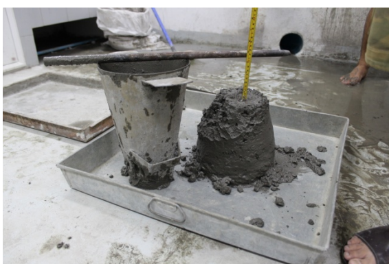
รูปที่ ง5 การวัดค่าการยุบตัวของคอนกรีต
