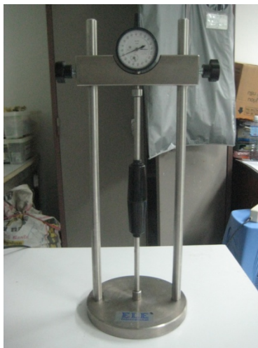
รูปที่ ข2 การสอบเทียบเครื่อง Length Comparator ด้วย Reference Bar ก่อนการวัดตัวอย่าง
