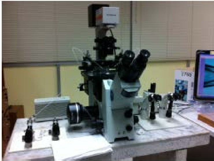
รูปที่ 10 ภาพการติดตั้ง Micromanipulation system เพื่อใช้ในการทำ Microinjection
