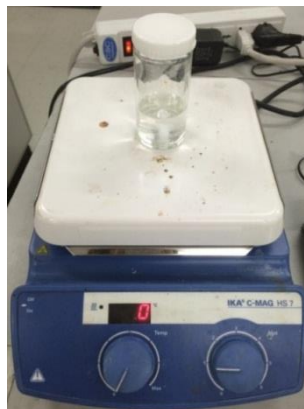
รูปที่ 3.32 การกวนสารที่ผสมให้เข้ากันของ \text{TiO}_2(\text{Sol})
