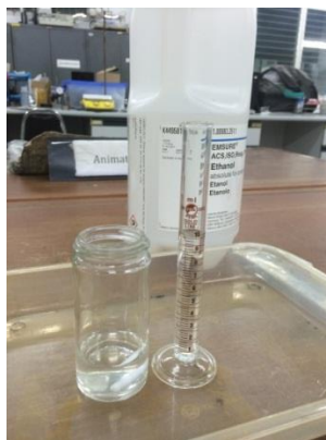
รูปที่ 3.30 การเตรียมสารสำหรับสังเคราะห์ไทเทเนียมไดออกไซด์ด้วยวิธีโซล-เจล
