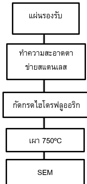
รูปที่ 3.21 ขั้นตอนการเตรียมแผ่นรองรับที่สังเคราะห์เส้นลวดนาโน
