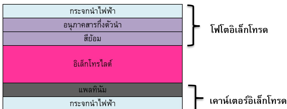
รูปที่ 2.2 แสดงโครงสร้างของ DSSC
