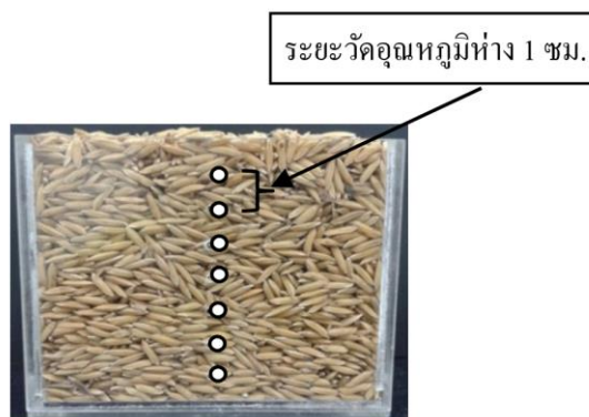
ภาพที่ 3-2 ตำแหน่งในการวัดอุณหภูมิด้วยสายเทอร์โมคัปเปิล
