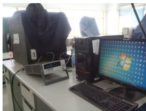
รูปที่ 3.8 แสดงแหล่งกำเนิดแสงและอุปกรณ์ที่ใช้ในการวัดประสิทธิภาพ DSSC ที่ความเข้ม 100 \text{ mW/cm}^2
