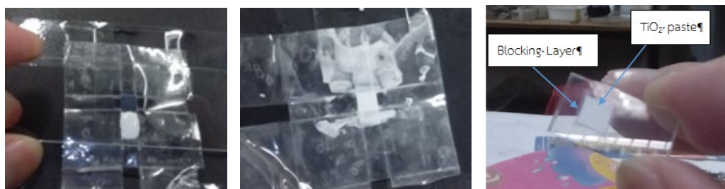
รูปที่ 3.4 แสดงการเตรียม paste ของ \text{TiO}_2 โดยวิธี Doctor Blade บนชั้น Blocking Layer
