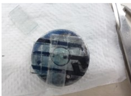
รูปที่ 3.3 แสดงการติดตั้งชิ้นงานบนฐานยึดชิ้นงาน
